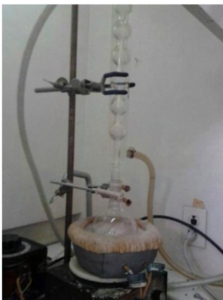
Figura 3-22: Baño de acetona con reflujo
