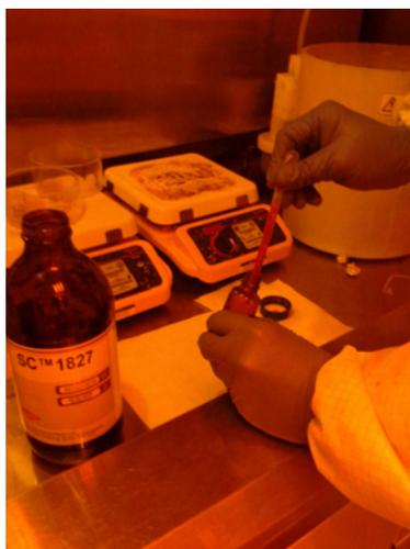
Figura 3-6: Depósito de resina del frasco madre al frasco ámbar.
