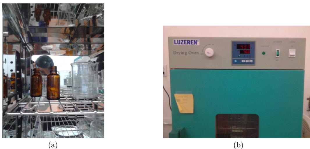
Figura 3-5: (a) Interior y (b) Exterior del horno de convección
