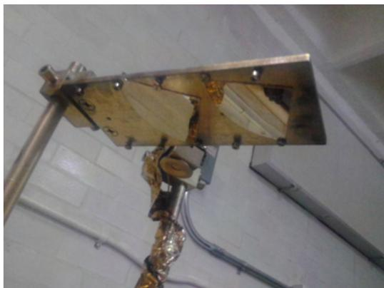
Figura 3-14: Muestras después del depósito de oro
