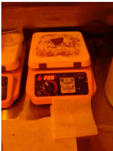
Figura 3-9: Oblea en la parrilla. Para retirarla, se empuja suavemente con las pinzas hacia el borde de la parrilla, donde se pueda tomar firmemente con las mismas.
