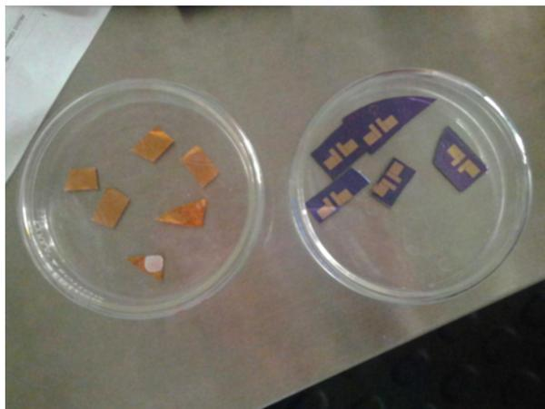
Figura 3-19: Corte de grafeno sobre cobre y de oblea para tener circuitos aislados.
