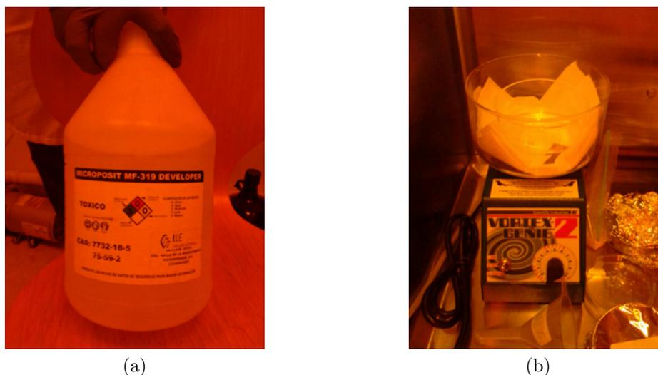
Figura 3-12: (a) Contenedor de revelador MF 319 (b) Cristalizador en agitador orbital
