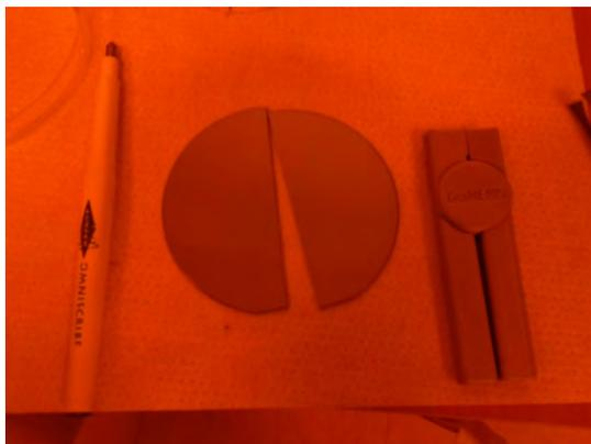
Figura 3-7: Corte de la oblea en dos. Se observa la punta de diamante y las pinzas del laboratorio *BioMEMS* para facilitar el corte.
