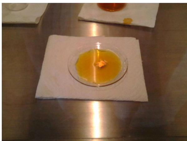
Figura 3-21: Grafeno con PMMA sobre cobre flotando en solución de  $\text{FeCl}_3$ .
