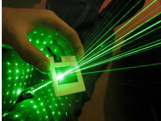
Figura 3.4. Un haz de láser es difractado utilizando una rejilla de difracción.
