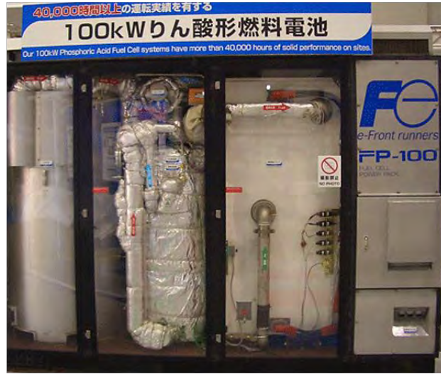
Figura 2.4. Esquema de funcionamiento de una PAFC y sistema de 100kW comercializado por Fuji Electric . (28)
