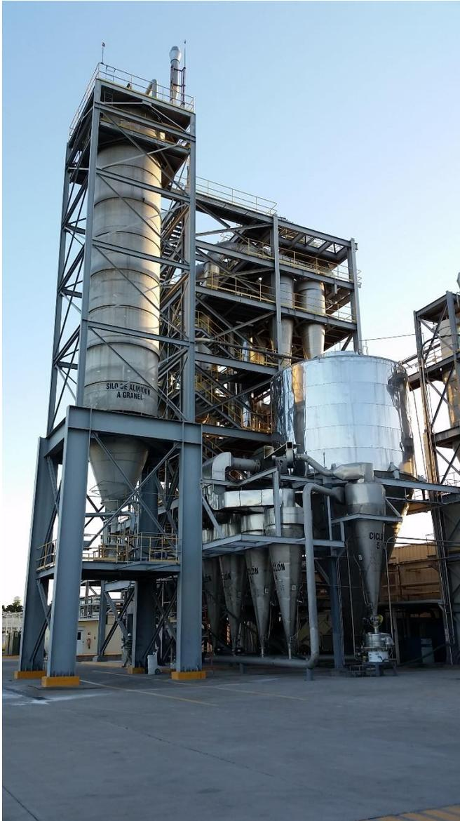
Fotografía de un conjunto de secadores, a la izquierda el silo de almidón para 200 ton. A la derecha el secador flash de almidón capacidad de 8 ton/hr, en la parte inferior derecha el secador spray cap. 1.5 ton/hr
