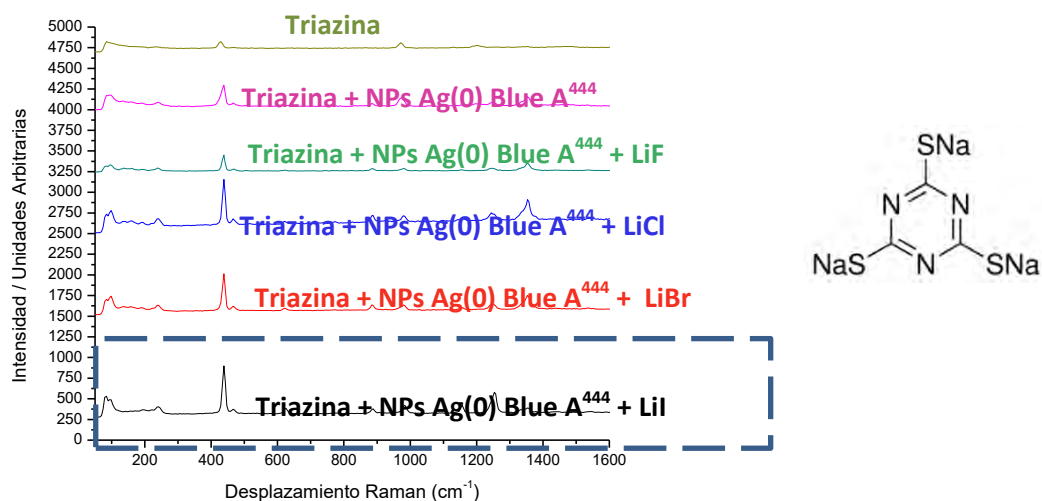
Gráfica 3.29 Comparativo de los espectros Raman de tritocianurato de sodio 0.1 mM en presencia de nanopartículas de Ag(0) Blue A 444 y compuestos iónicos de litio, ambos en concentración 0.1 mM, y a temperatura ambiente
