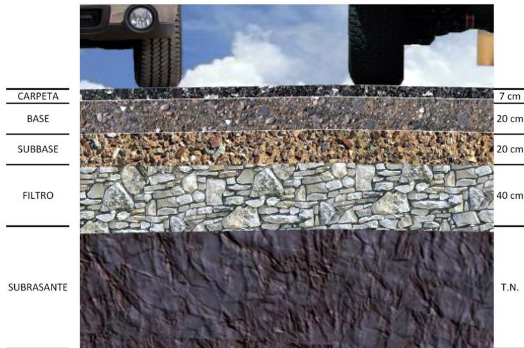
Ilustración 19. Sección transversal del pavimento. (CICC, 2013).
