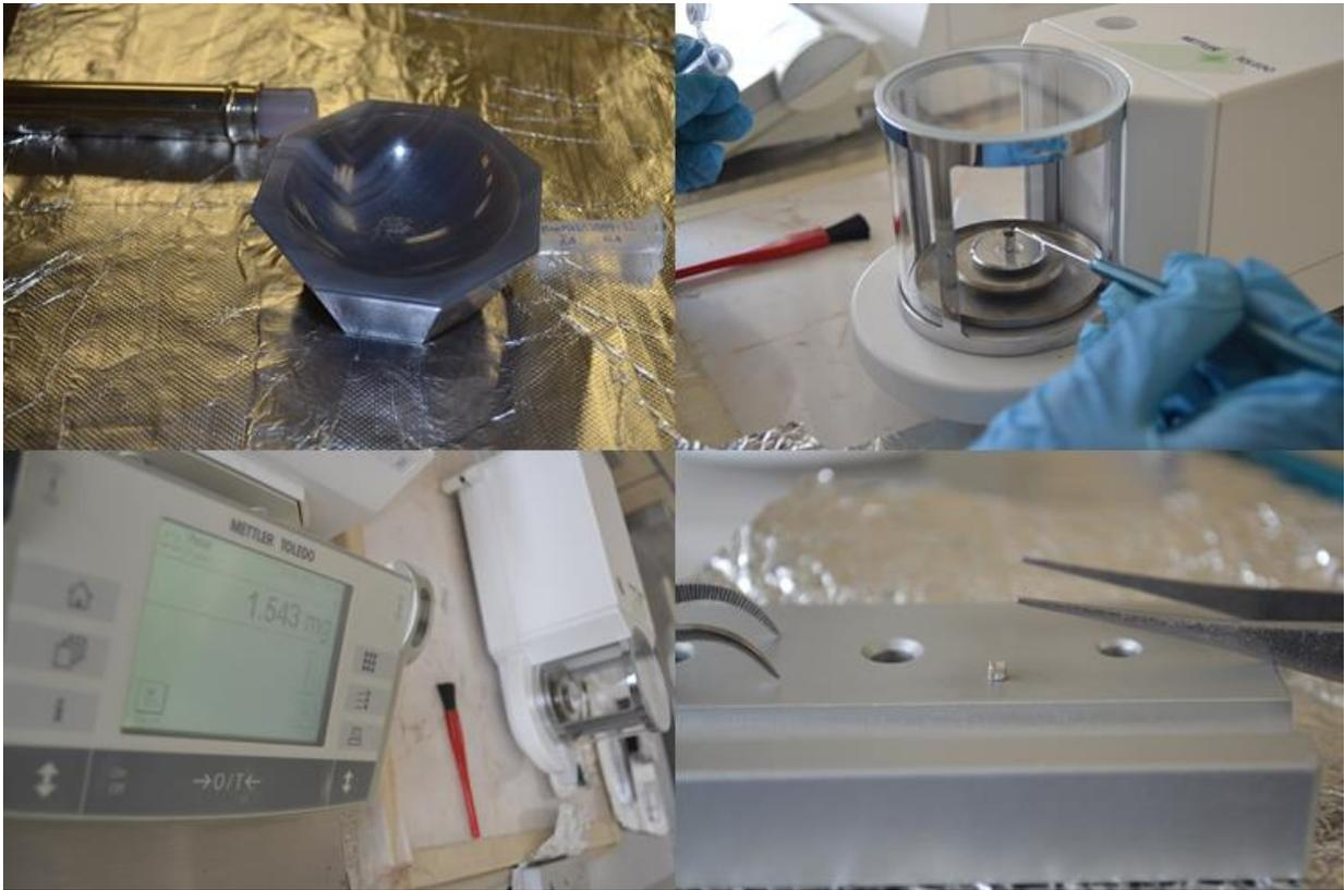
**Figura 10. Homogeneizado y encapsulado de muestras.**
