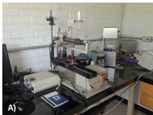
Figura 24. A) y B) Goniómetro con control de video y dispensador de goteo controlado Ramé-Hart Instrument Co., con software de análisis de imagen y procesamiento de muestras ImageJ
