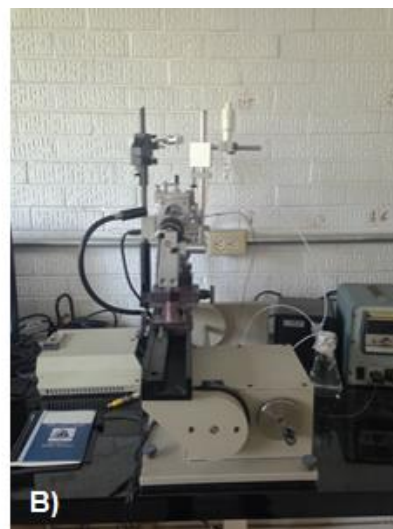
Figura 24. A) y B) Goniómetro con control de video y dispensador de goteo controlado Ramé-Hart Instrument Co., con software de análisis de imagen y procesamiento de muestras ImageJ
