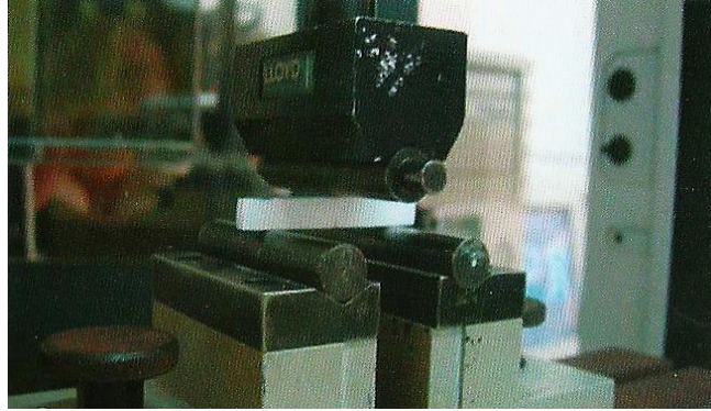
Figura 16. Prueba de Flexión Monoaxial a tres puntos. 8
