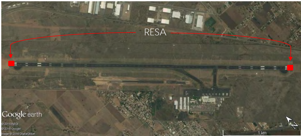
Imagen 21. Áreas de seguridad de extremo de pista
