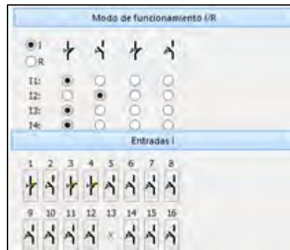
Imagen 3.7 modo de funcionamiento de entradas
