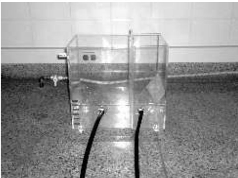
Fig. 2.20. Reactor de mezcla completa de laboratorio utilizado para la determinación de los coeficientes cinéticos sin recirculación de sólidos (Varila-Quiroga y Díaz-López, 2008)
