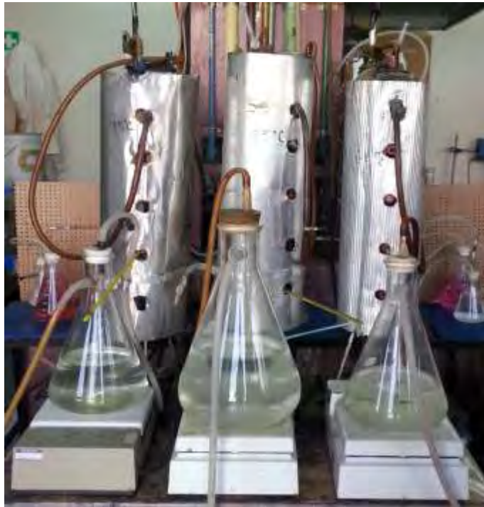
Fig. A1. RALLFA operando a 45, 55 y 65°C (los matraces Erlenmeyer contienen el agua de calentamiento empleando las parrillas donde están soportados)
