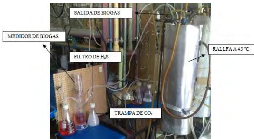
Fig. 3.2. Los reactores RALLFA a 45, 55 y 65°C (en esta investigación solamente se consideraron los de las dos primeras temperaturas) con trampa de CO 2 , filtro de H 2 S y medidor de biogás por desplazamiento de agua
