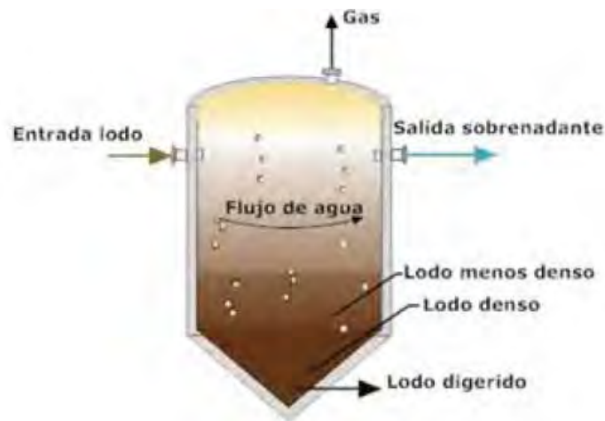
Fig. 2.4. Digestor de baja tasa (Noyola-Robles et al., 2013)
