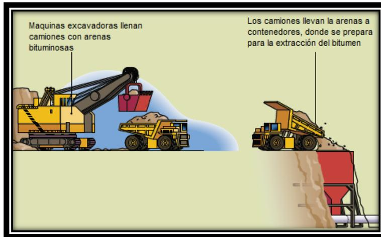
Fig. 2.2. Proceso de minado de las arenas bituminosas encontradas a poca profundidad.<sup>2</sup>
