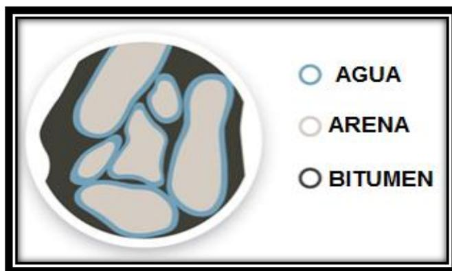
**Fig.2.1. Esquema de los distintos componentes de las arenas bituminosas.<sup>1</sup>**
