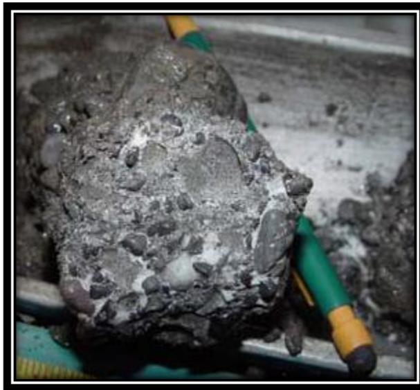
**Fig.6.5. Núcleo recuperado de un talud en el norte de Alaska donde se aprecian hidratos de metano actuando como cementante en sedimentos de grano grueso.<sup>41</sup>**
