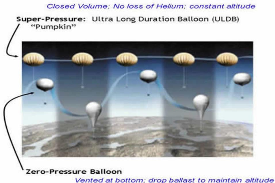
Figura 1.3: Representación conceptual de la comparación entre el vuelo de un globo de super presión y uno de presión cero [28].
