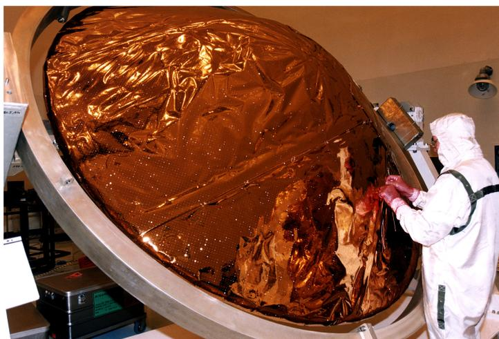
Figura 2.9: Instalación de MLI a la sonda espacial Huygens en 1997 [33].
