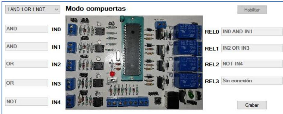
Figura 5.8 Configuración de pestaña “Compuertas”.
