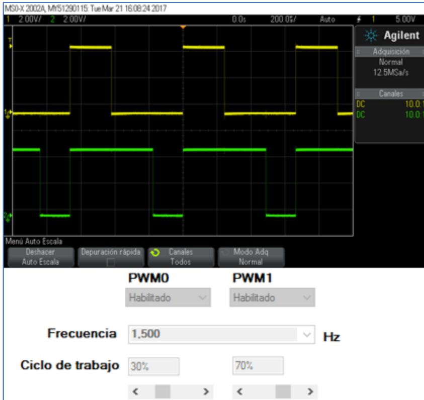
Figura 5.16 Visualización en osciloscopio.
