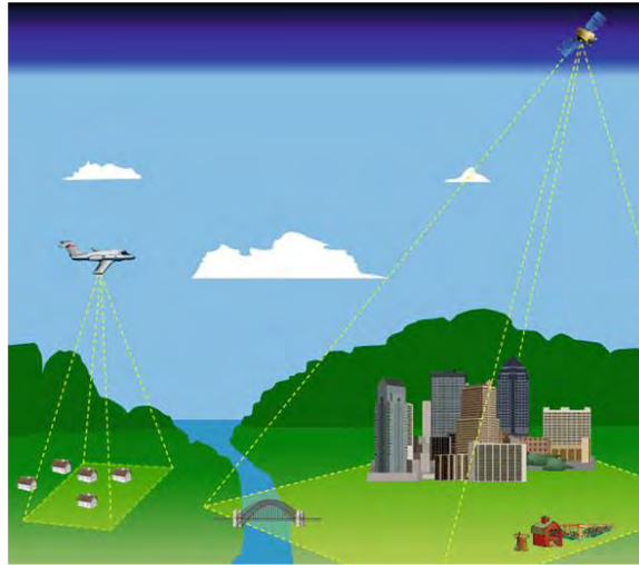
Figura 3. Se muestran dos tipos de plataformas y sus campos de visión tomado de Khorram y Koch (2012).
