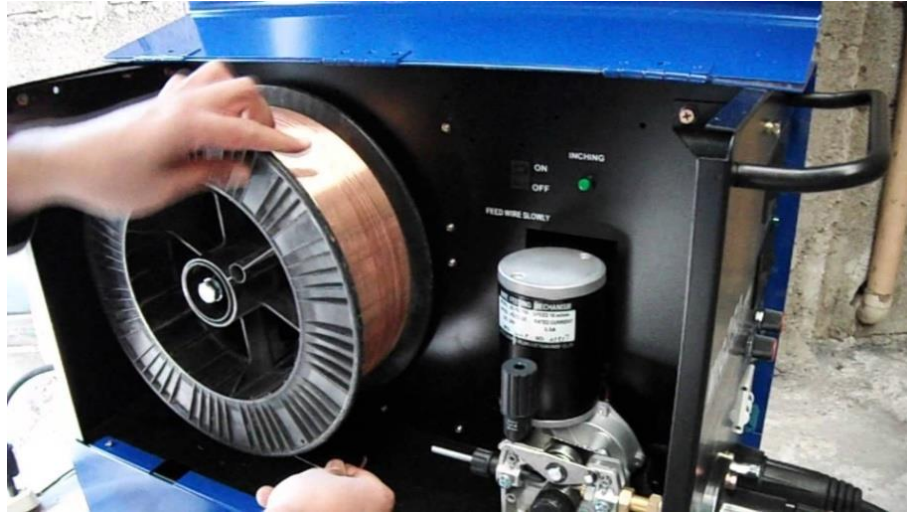
Fig. 21 Soldadura con microalambre.
