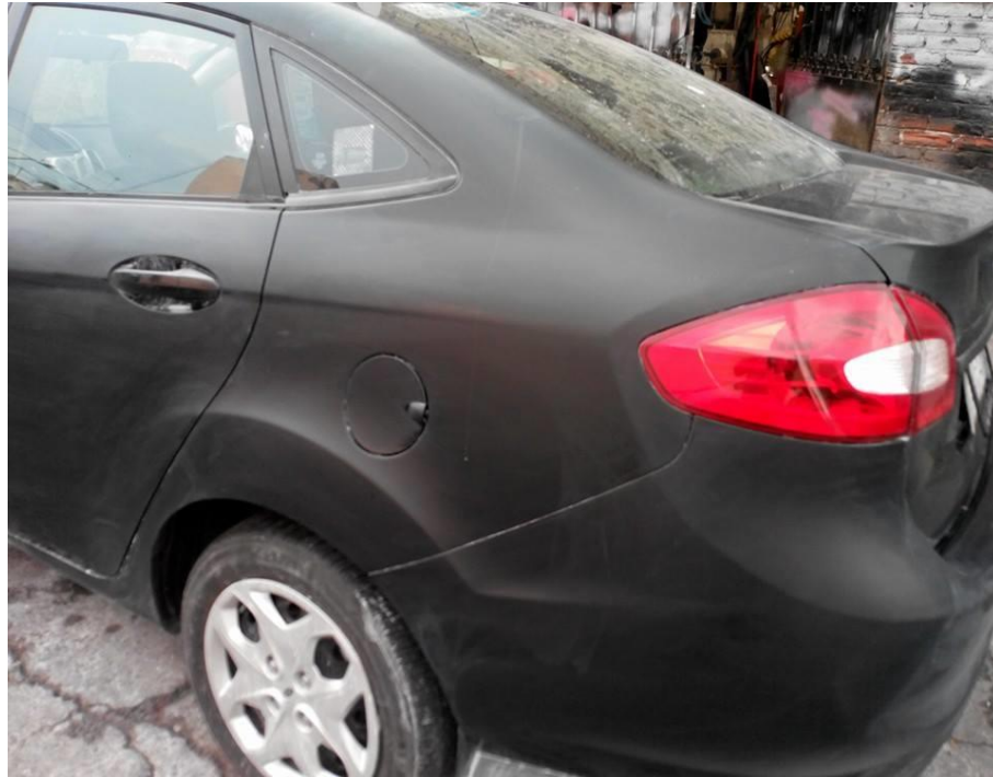
Fig. 86 Matizado con lijas de agua de grano 1000, 2000 y 3000 a mano.
