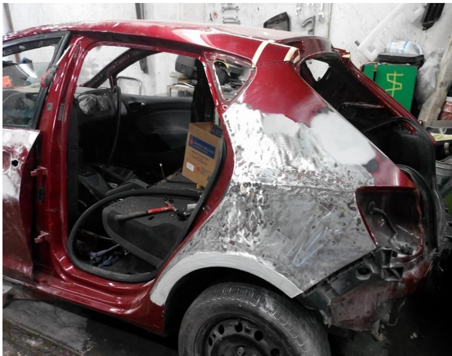
Fig. 45 Reparación de costado izquierdo trasero.
