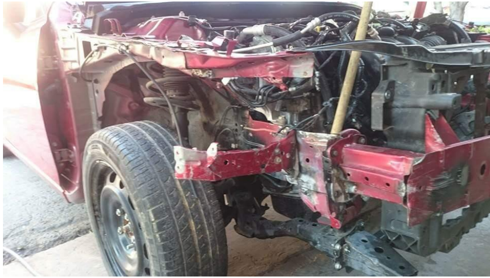
Fig. 15 Base de salpicadera enrezada, soldado de alma con puntas.
