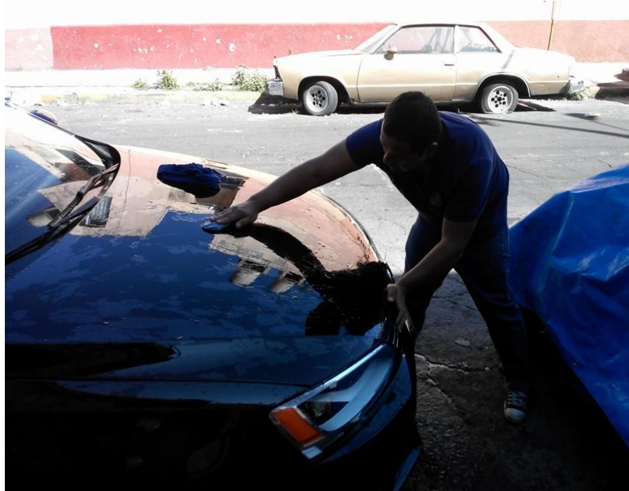
Fig. 80 Descontaminado de pintura.
