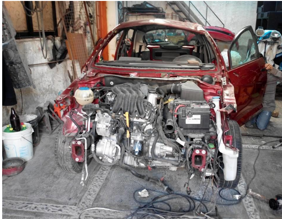
Fig. 35 Daños en parte frontal Ibiza.
