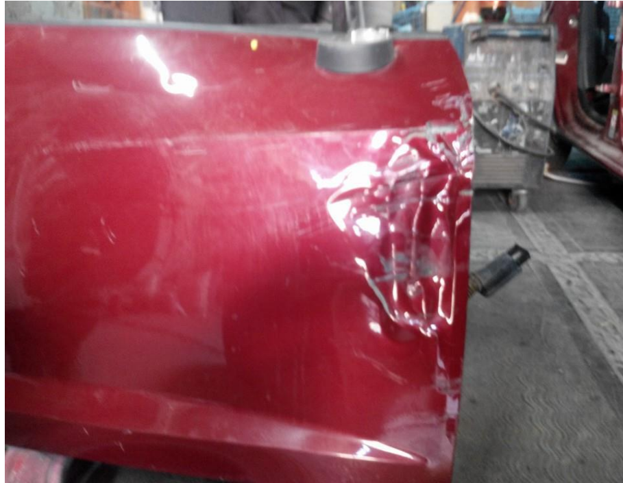
Fig. 42 Daño de puerta delantera derecha.
