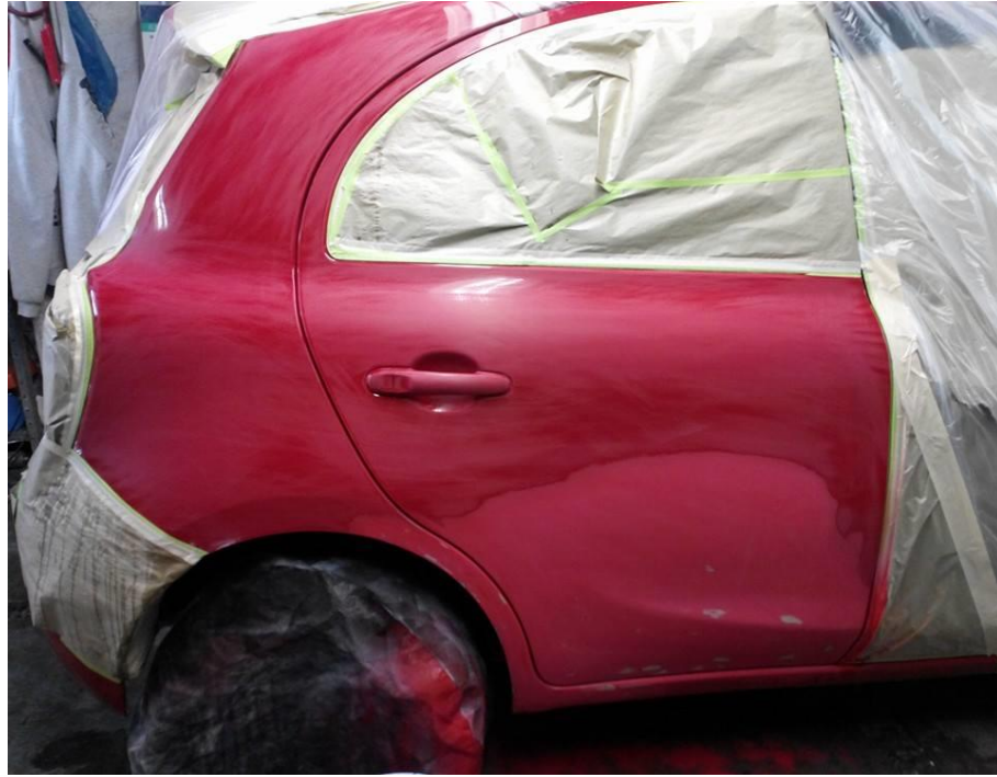
Fig. 74 Pintado del daño.
