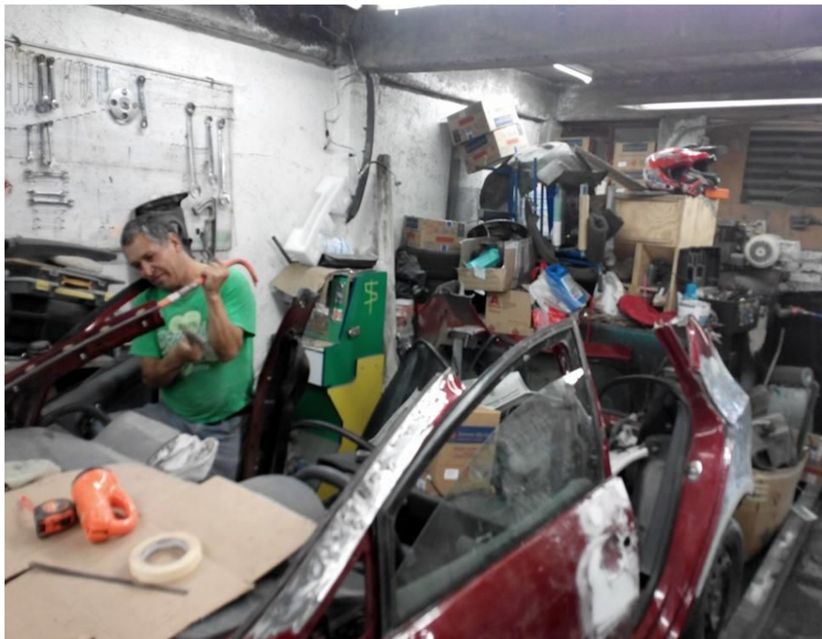
Fig. 47 Toldo cortado para colocar uno nuevo.
