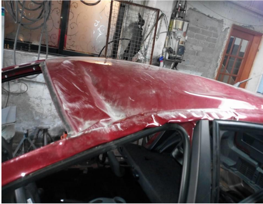
Fig. 36 Daños en toldo.
