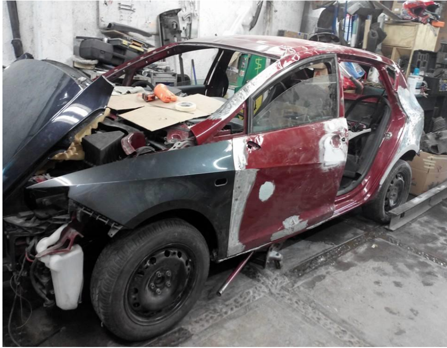
Fig. 46 Reparado de costado izquierdo completo.
