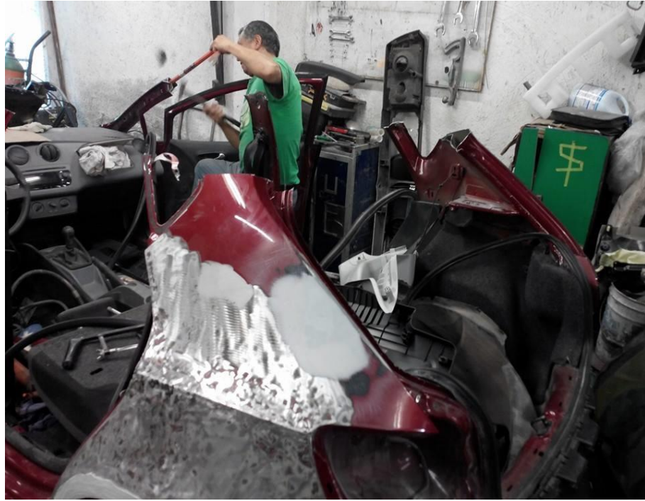
Fig. 48 Abriendo postes para colocar toldo nuevo.
