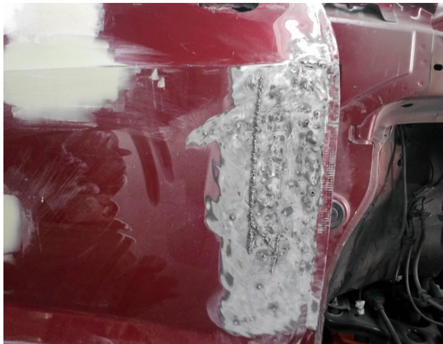
Fig. 43 Reparación de puerta delantera derecha.
