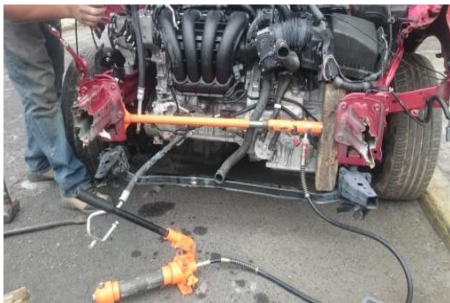
Fig. 10 Abriendo puntas para acomodar el alma. Esta herramienta fue fundamental para abrir las puntas de este Mazda 2016 y así poder soldar y salvar el alma.
