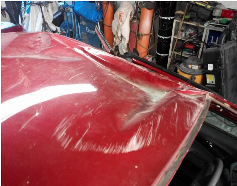
Fig. 37 Daños en toldo.
