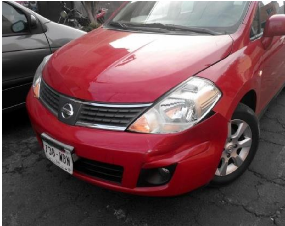
Fig. 30 Golpe en fascia delantera Tiida.
