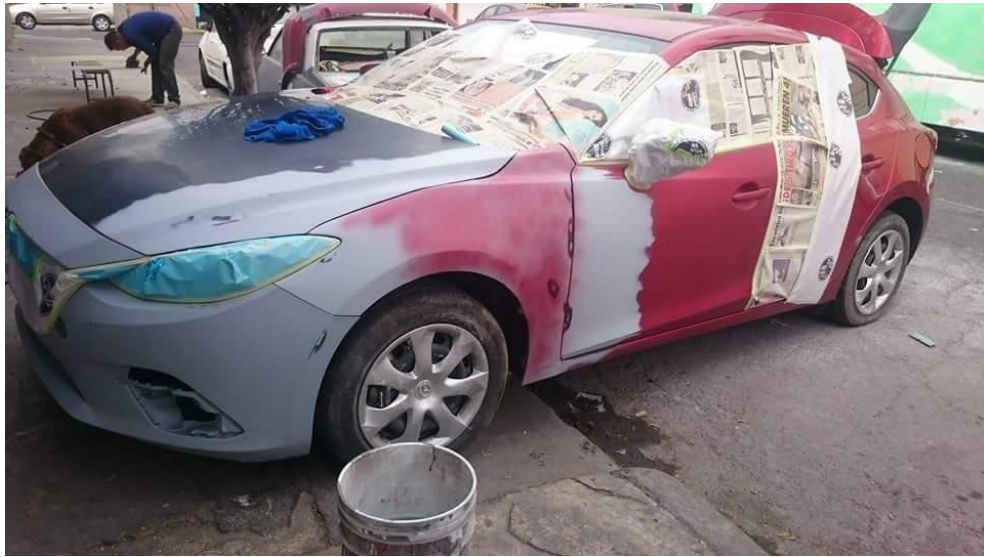
Fig. 17 Armado de frente, empapelado y preparado para pintar.
