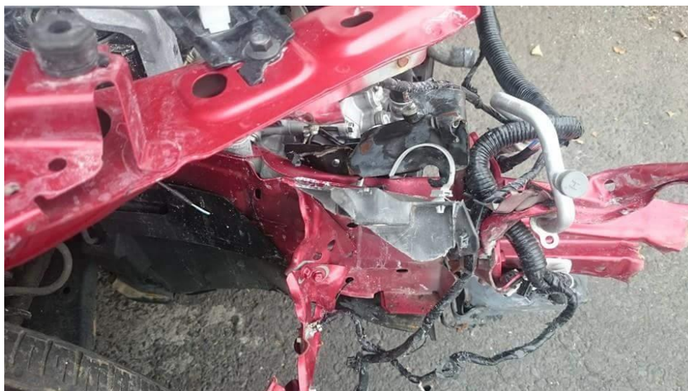
Fig. 12 Daño en puta derecha y base de salpicadera.
