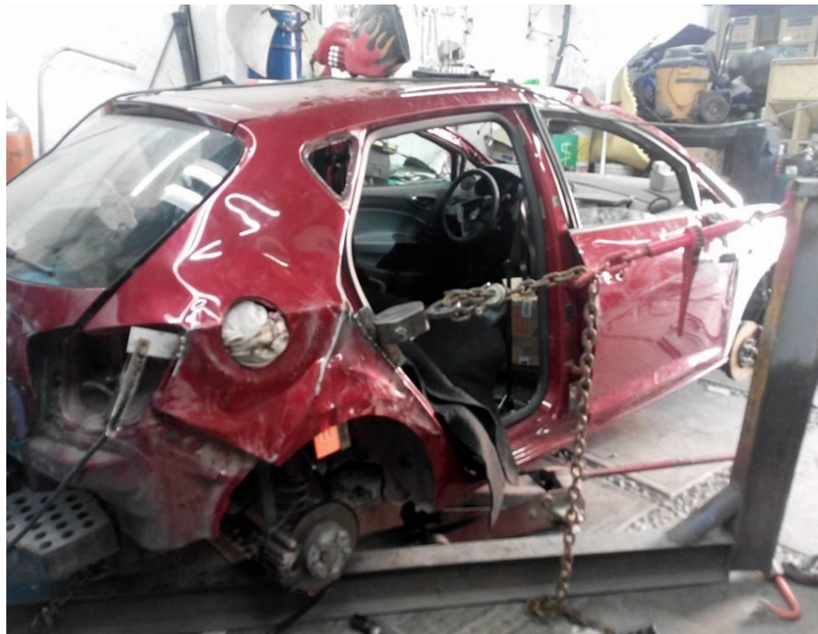
Fig. 41 Jalando costado derecho trasero.
