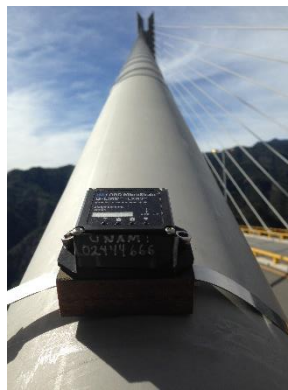
Figura 2.13 Instalación de acelerómetro en el Tirante 19 y de estación meteorológica
