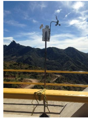
Figura 2.12 Instalación de acelerómetro en el Tirante 9 y de estación meteorológica
