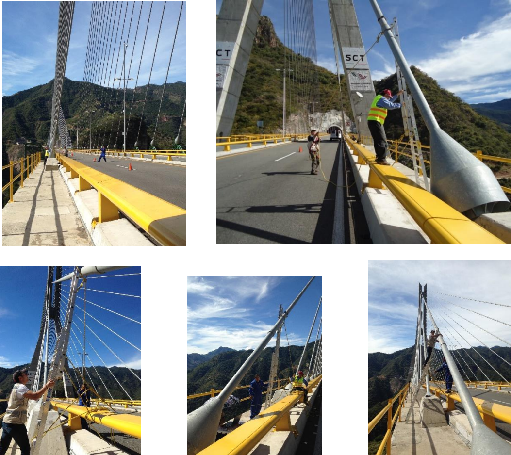
Figura 2.14 Prueba del tirón en los puentes probados
