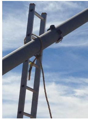
Figura 2.12 Instalación de acelerómetro en el Tirante 9 y de estación meteorológica
