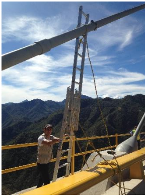
Figura 2.12 Instalación de acelerómetro en el Tirante 9 y de estación meteorológica
