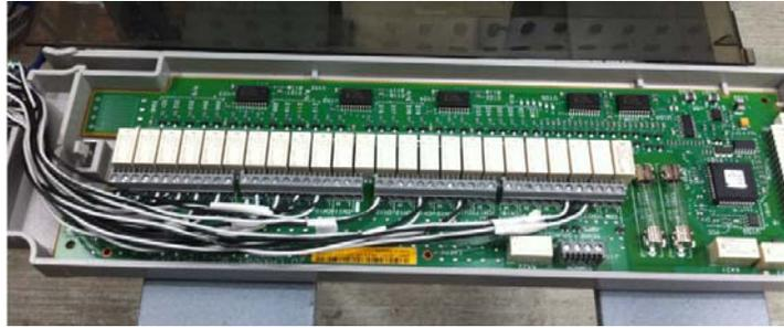
Figura 4.27.- Tarjeta multifunción Agilent 34907A número uno, con los sensores conectados.
