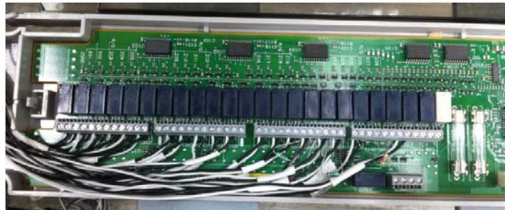
Figura 4.28.- Tarjeta multifunción Agilent 34907A número dos, con los sensores conectados.
