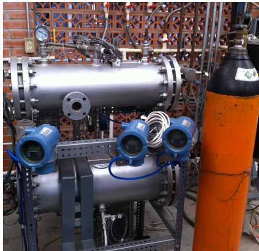
Figura 4.35.- Sistema presurizado a 10 bar en el absorbedor y 20 bar en el resto del sistema de aire acondicionado solar.
