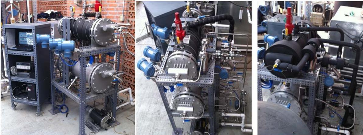
*Figura 4.36.- Resultado final de la integración de los diversos componentes del sistema de aire acondicionado solar.*
