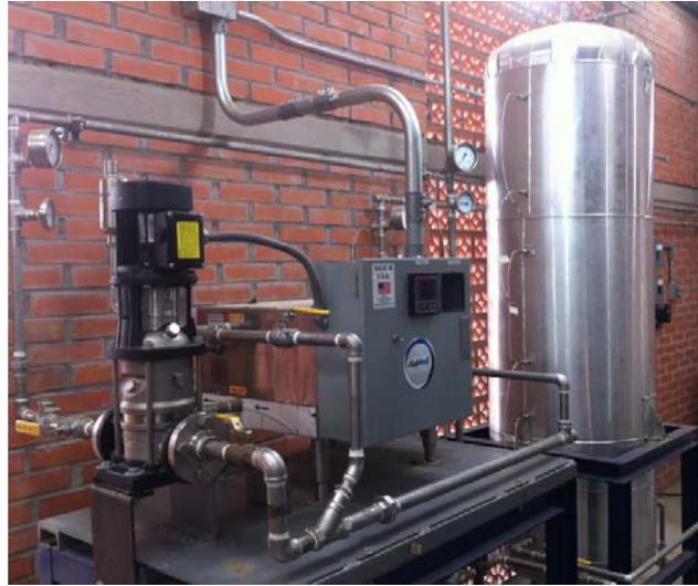
Figura 4.33.- Tanque de almacenamiento de 700 litros acoplado al sistema de calentamiento auxiliar.
