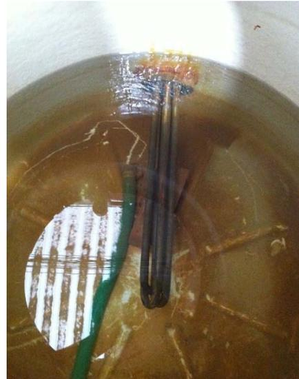
Figura 4.34.- Tanque de almacenamiento de agua a enfriar, con tres resistencias eléctricas y bomba.
