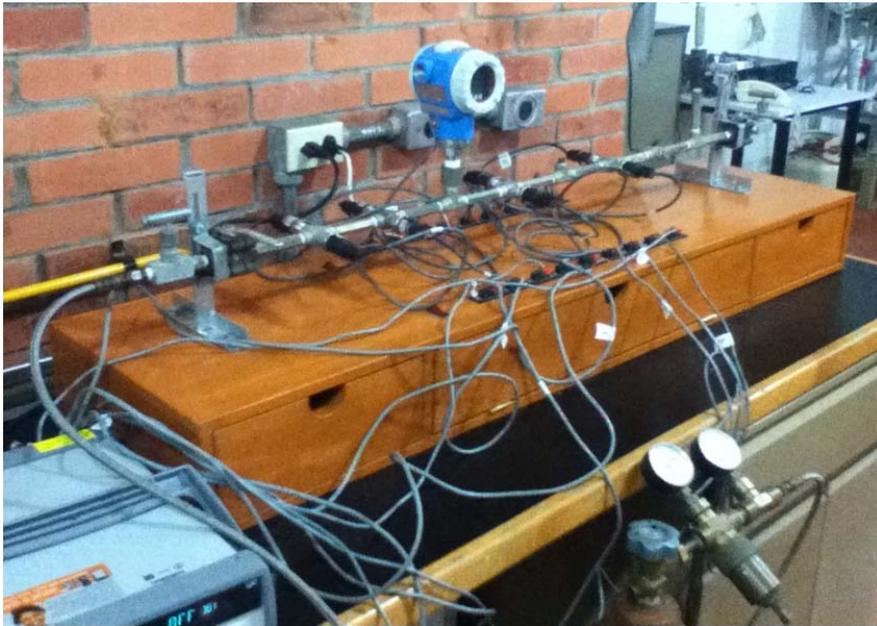
*Figura 4.19.- Banco de calibración con los sensores montados, junto con el tanque de nitrógeno y adquisidor de datos.*
