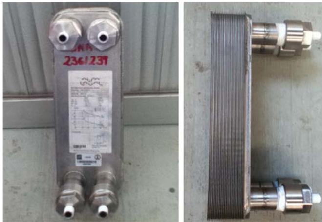
Figura 4.6.- Intercambiadores de placas empleados en el sistema de aire acondicionado solar.
