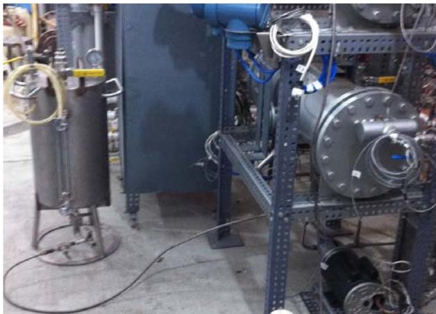
Figura 4.40.- Inyección de la mezcla amoníaco/nitrato de litio al sistema de refrigeración solar.
