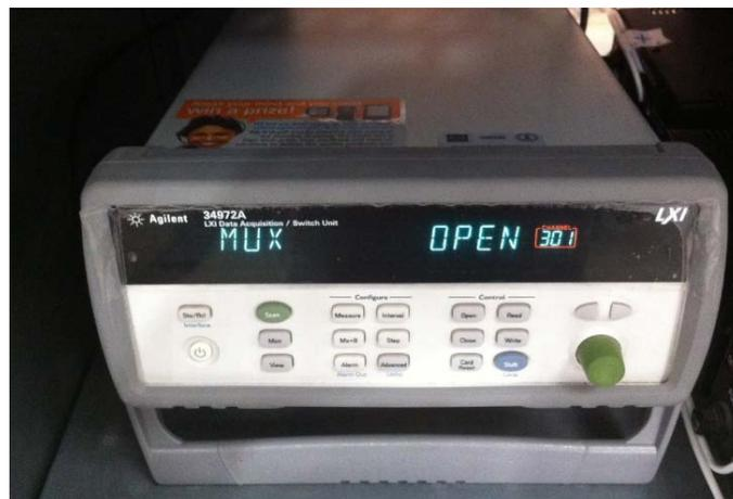
Figura 4.29.- Adquisidor de datos marca Agilent modelo 34972A.
