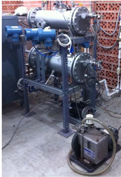
*Figura 4.39.- Bomba de vacío conectada al sistema de aire acondicionado solar.*
