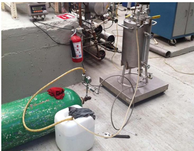
Figura 4.38.- Elementos empleados para la carga de amoníaco.
