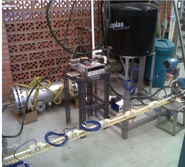
Figura 4.22.- Circuito de medición empleado para la calibración de los sensores de flujo volumétrico.
