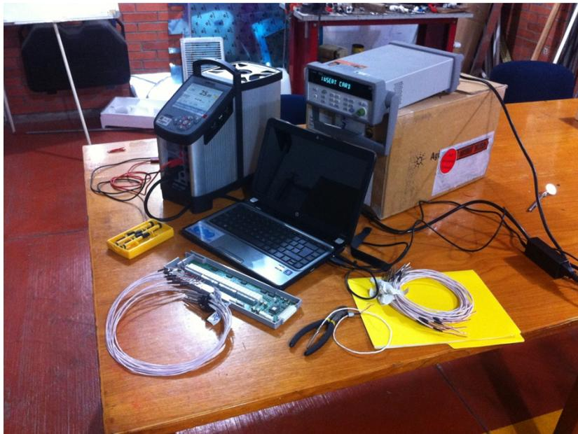
Figura 4.17.- Componentes necesarios para la calibración de los sensores de temperatura.
