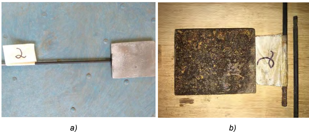
Figura 4.13 a) Cupón de acero al inicio del experimento. b) Cupón al final del experimento después de 6 meses.
