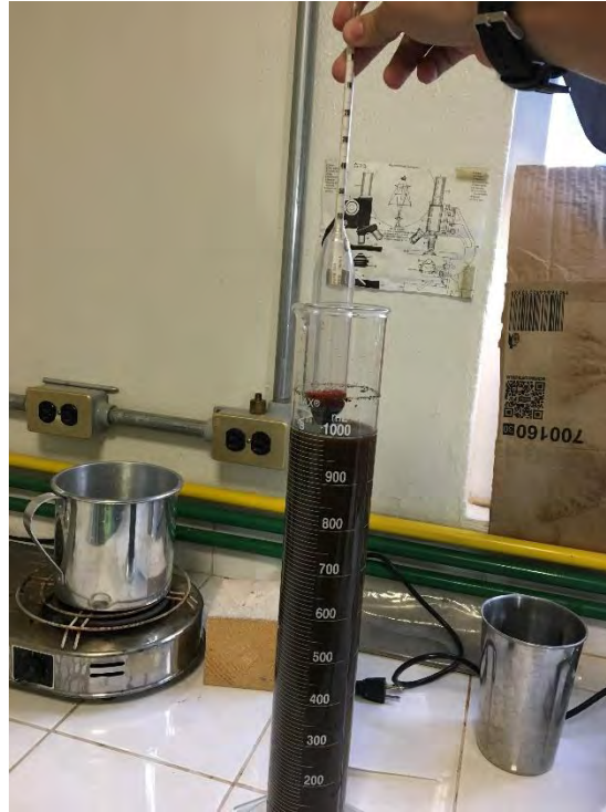
Figura 4.4 Probeta graduada con hidrómetro para medir la textura del suelo por el método de Bouyoucos.
