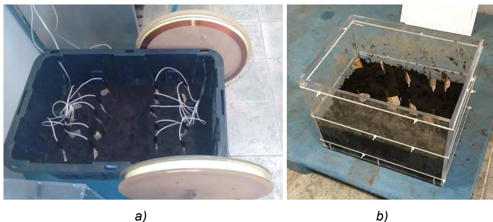
Figura 4.14. a) Imagen de la cuba con 20 cupones, de los cuales 10 fueron protegidos catódicamente y los otros 10 también pero bajo el campo magnético, b) 10 cupones de referencia (sin PC y sin CM).
