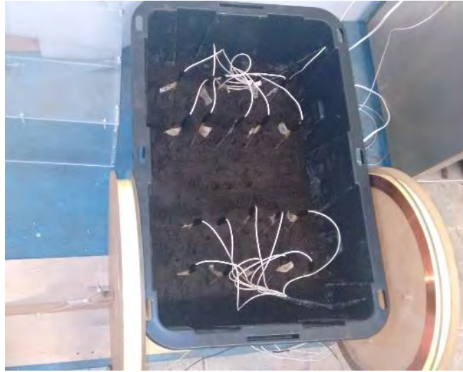
Figura 4.15 Cuba experimental bajo protección catódica donde la sección superior no es afectada por el campo magnético.
