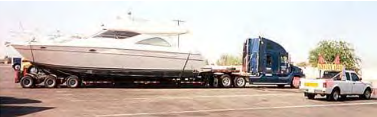
Figura 30. Cama baja para el traslado terrestre de embarcaciones.
