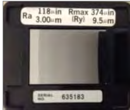
Figura 72. Espécimen de calibración.
