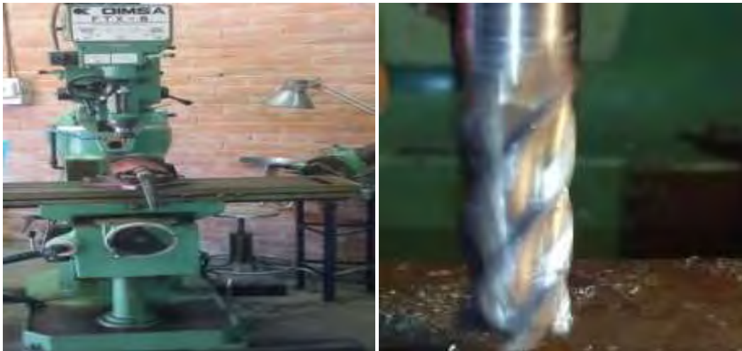
Figura 90. a) Fresadora vertical OIMSA MODELO FTX-8, b) Cortador de carburo de Tungsteno
