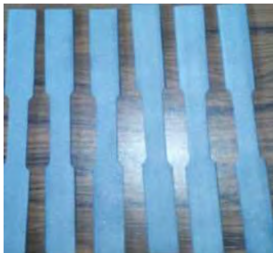
Figura 97. probetas después del proceso de sand blast.
