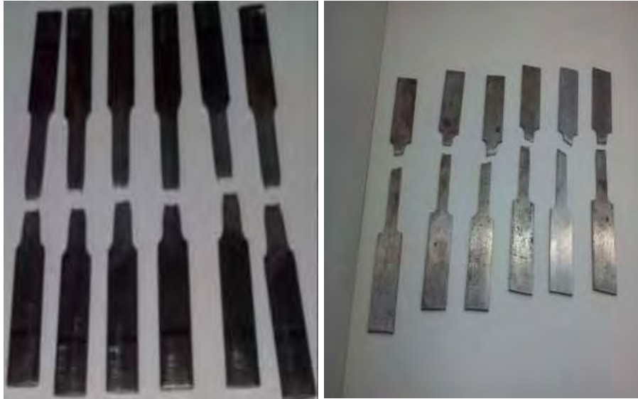
Figura 106. probetas después del ensayo de tensión.
