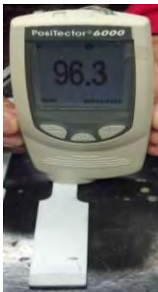
Figura 103. Medición de espesor de las probetas de acero 1010 y acero 1018
