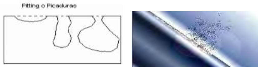
Figura 26. Corrosión por picadura.
