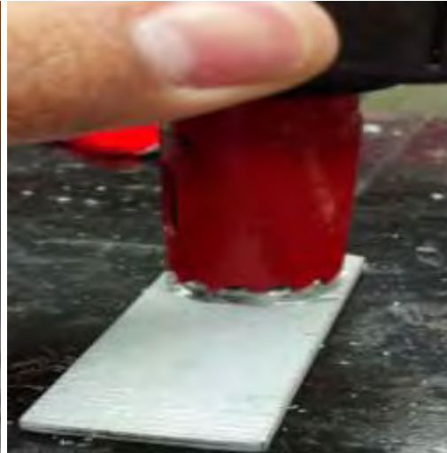
Figura 109. Eliminación del exceso de pegamento.
