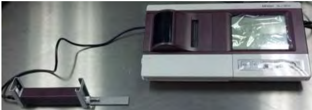
Figura 99. Aplicación de la Prueba de rugosidad.
