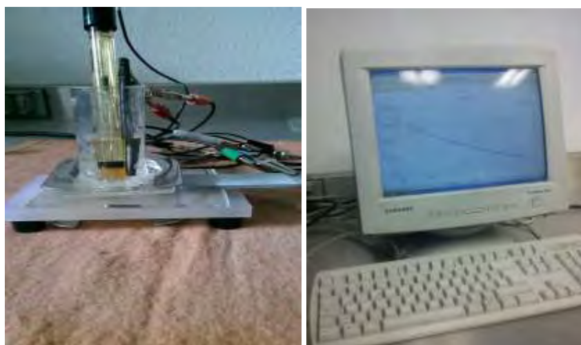
Figura 112. Prueba de corrosión y aplicación de software Gamry
