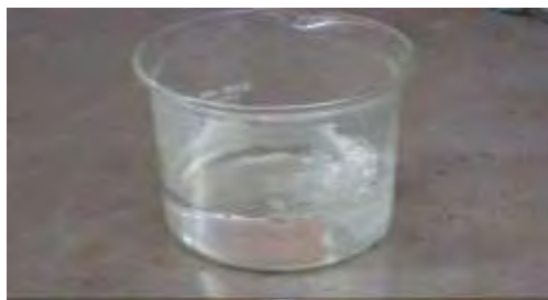
Figura 31. Zinc reaccionando con HCl diluido para producir hidrógeno gas.
