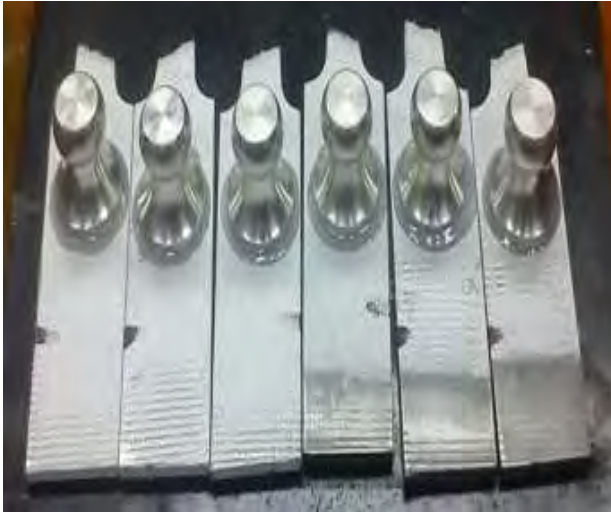
Figura 108. Colocación de los Dollys en las probetas
