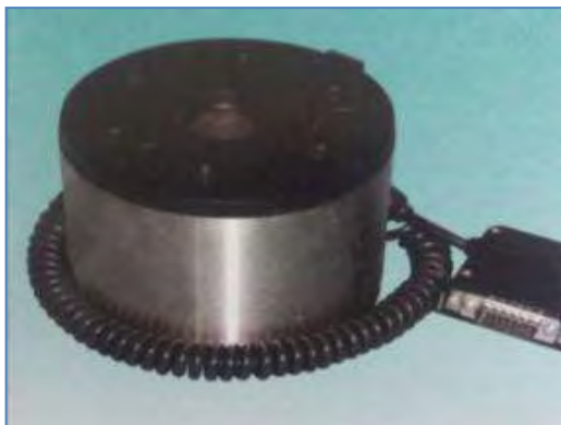
Figura 43. Célula de carga de equipos Instron
