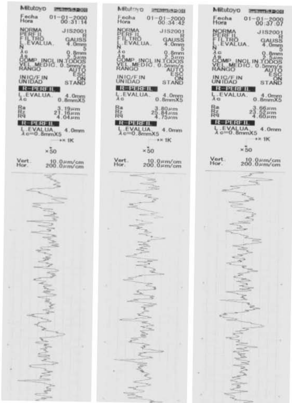
Figura 124. Prueba de rugosidad acero 1018 rolado en frio.
