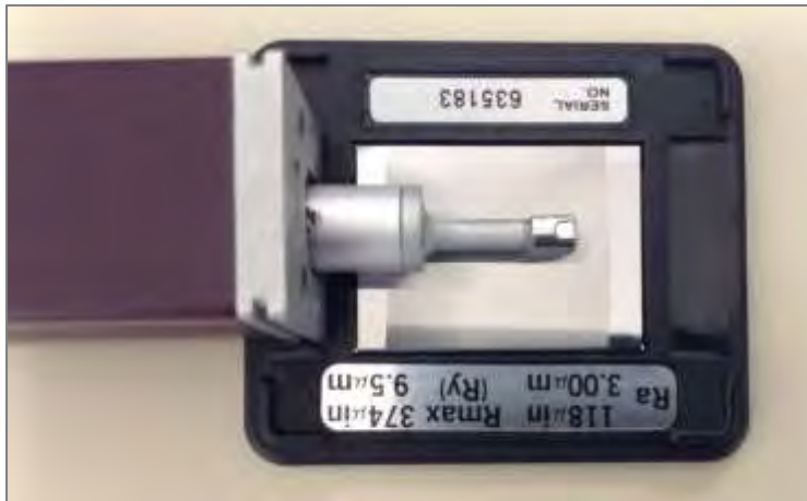
Figura 74. Calibración del Rugosímetro.
