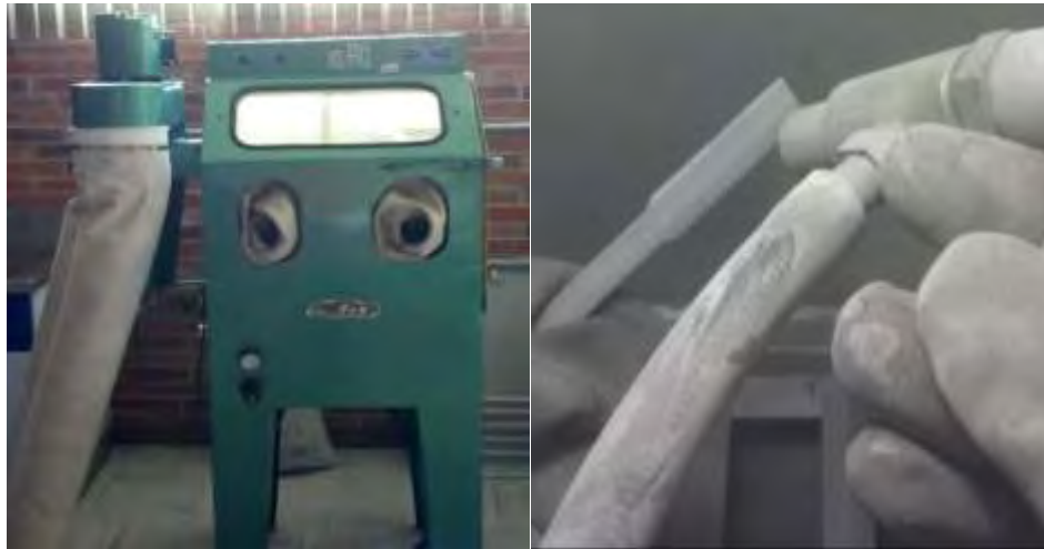
Figura 96. a) Máquina de sand blast modelo RRX1 b) Proceso de sand blast.
