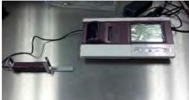
Figura 63. Prueba de rugosidad.
