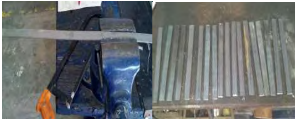
Figura 89. Corte las probetas del acero 1010 y 1018.
