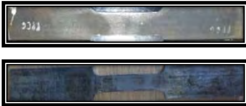
Figura 94. Forma de las probetas según la norma ASTM E8.
