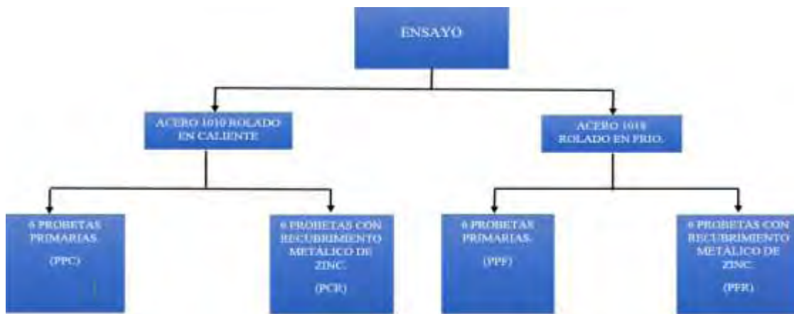
Figura 87. Esquema del ensayo para las probetas 1010 y 1018
