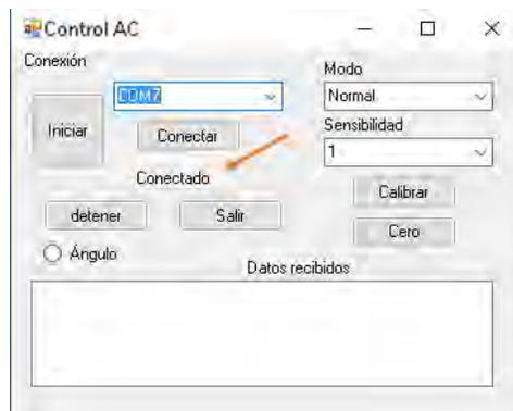
Figura 30 Interfaz Conectado con el circuito electrónico
