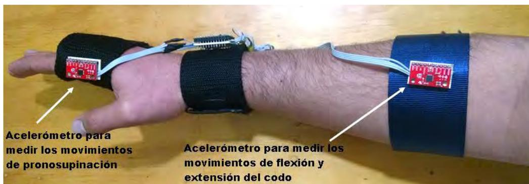
Figura 26 Configuración de acelerómetros
