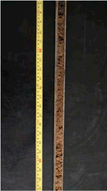
Figura 10. Fotografía de laboratorio con la parte superior del núcleo de prospección con las capas E15, E16 y E17. Se observan cambios más graduales de coloración con tonalidades más oscuras en la parte superior (E15) y más amarillentas en la parte inferior (E16 y E17).
