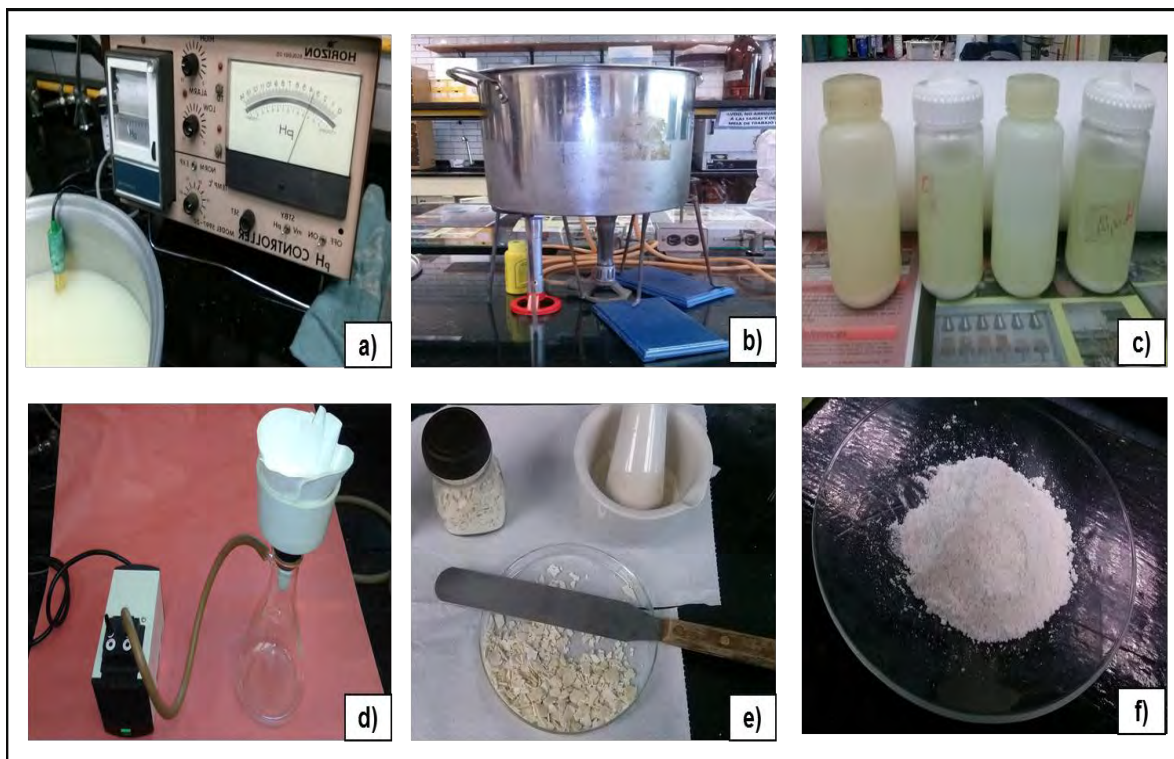
Figura 13. Aislamiento de proteínas del lactosuero. Acidificación (a); Calentamiento (b); Centrifugación (c); Filtración al vacío (d); Molienda (e); Proteína aislada de lactosuero en polvo (f).
