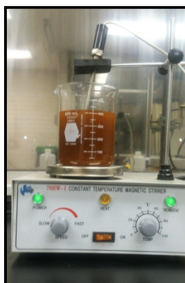
Figura 4.4.3. Lavado de los polvos, en una mesa de agitación magnética con control de temperatura.
