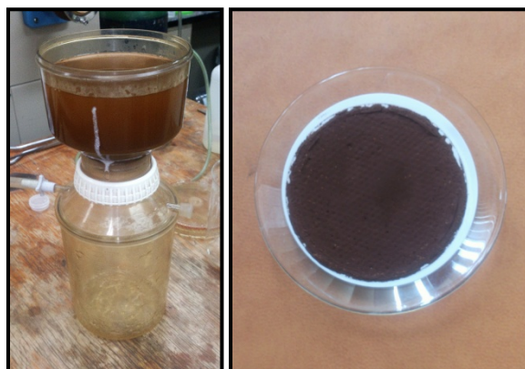
Figura 4.4.4. Aparato de filtración y polvo en filtro de nitrocelulosa después del proceso de filtración.
