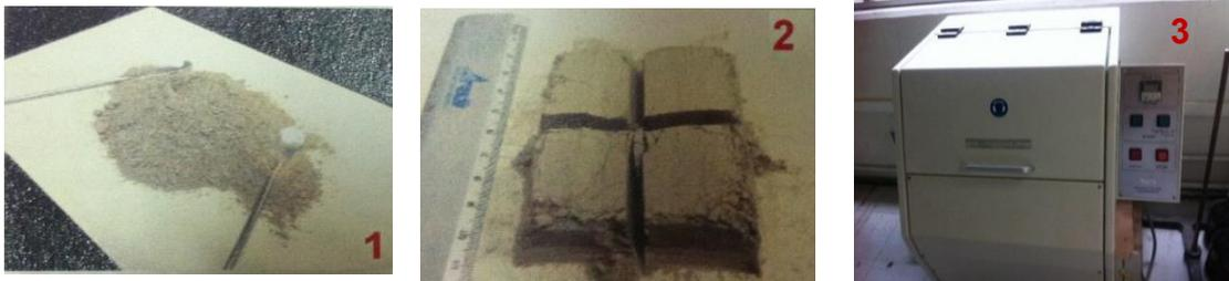
**Figura II-7** Muestras pulverizadas (1), fraccionamiento de las muestras (2), equipo pulverizador (3).
