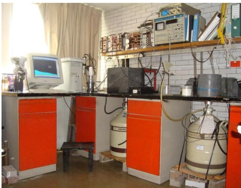
**Figura II-15** Detector de Germanio Hiperpuro, marca ORTEC. Laboratorio A-23, Instituto de Física, UNAM.
