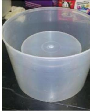
**Figura II-6** Geometría del Contenedor Marinelli
