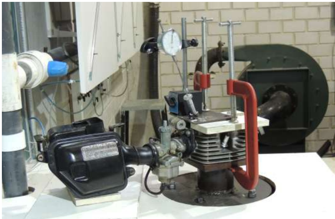
Fig. 4.8 Conjunto del sistema de admisión
