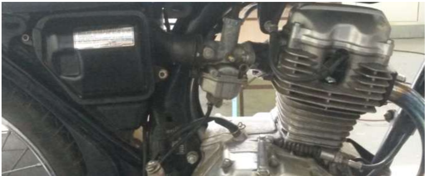
Fig. 4.1 Sistema de admisión de motocicleta Honda CGL 125
