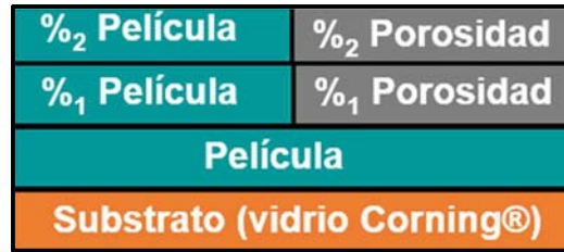
Figura 23. Esquema de capas utilizadas para el ajuste de los datos obtenidos por espectrofotometría UV-Visible.
