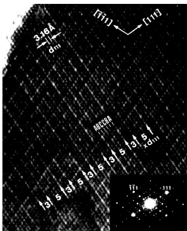
Figura 3. Micrografía obtenida por microscopía electrónica de transmisión de una muestra con estructura tipo II en la cual se indica la modulación de la periodicidad, y su patrón de difracción de electrones en eje de zona [110] respecto a la celda de la fluorita. Pueden observarse las reflexiones satélites características de una superred [40].
