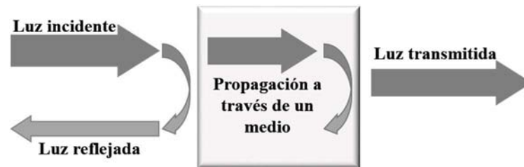
Figura 17. Fenómenos ocurridos durante la propagación de la luz por un medio óptico [88].
