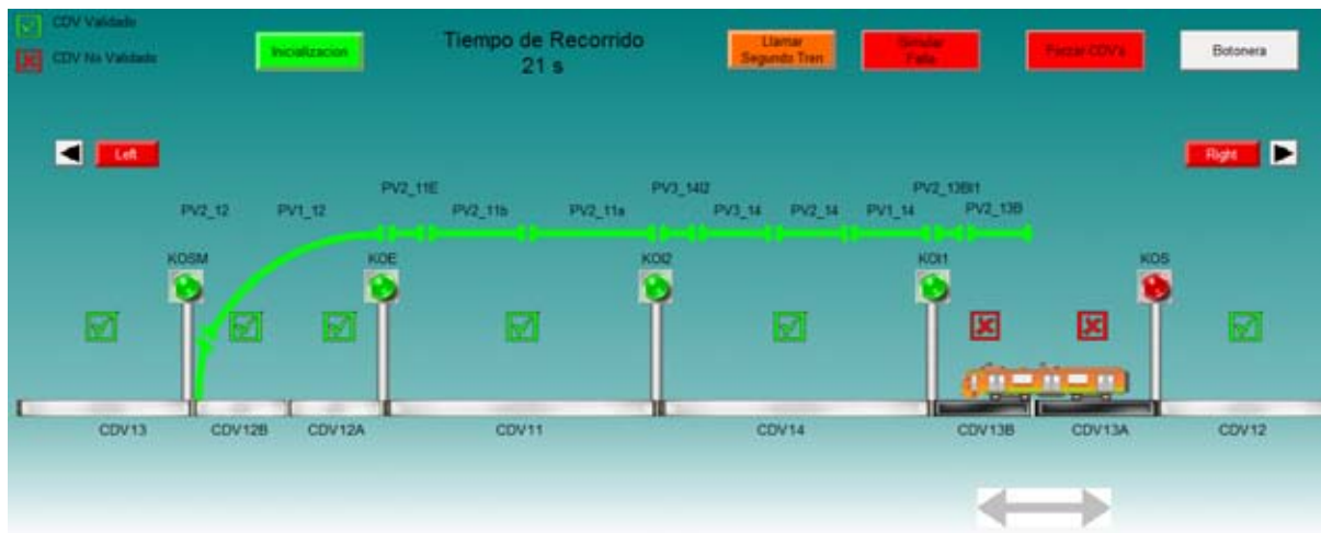
Figura 4.29. Flujo de vía reestablecido
