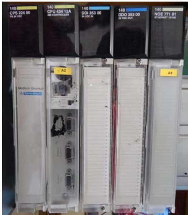
Figura 4.1. Módulos del PLC de Schneider Electric en un rack de 10 ranuras
