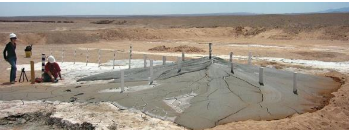
Figura 8. Jales espesados, proyecto Esperanza, Chile (SRK Consulting, 2010).
