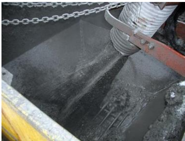
Figura 12. Jal como relleno de minas subterráneas (Tailings.Info, 2016).
