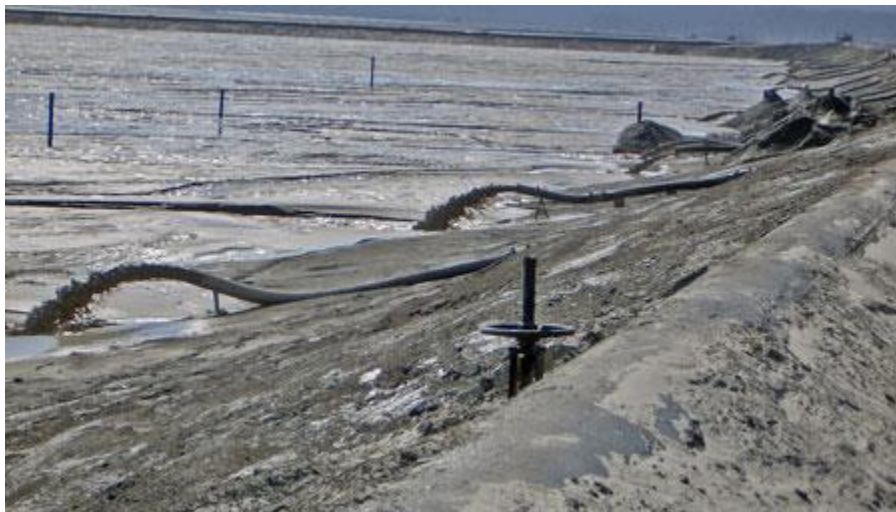
Figura 2. Conducción de jales hacia depósito (Tailings.Info, 2016)
