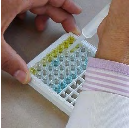
Figura 41. Cambio en la coloración de la reacción al adicionar la solución sustrato.
