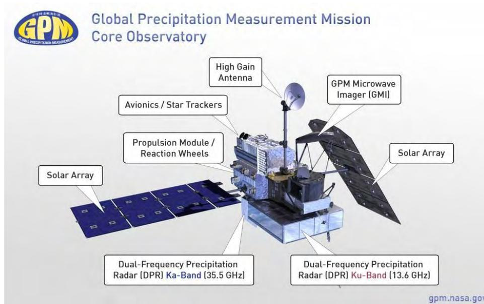
Imagen 17 Instrumentos satélite GPM
