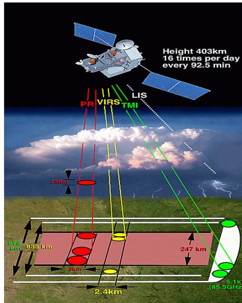
Imagen 16 Instrumentación en la misión TRMM
