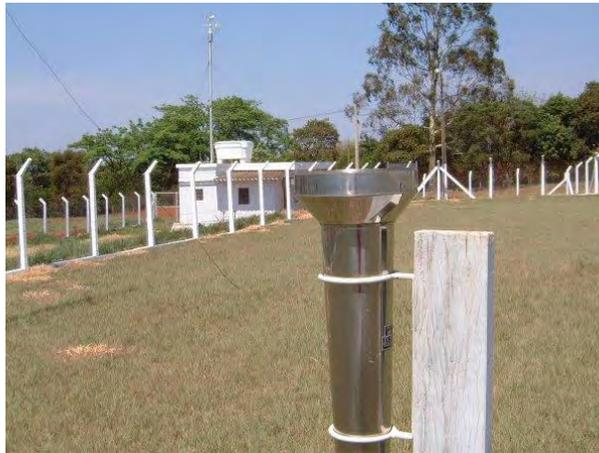
*Imagen 2 Pluviómetro*
