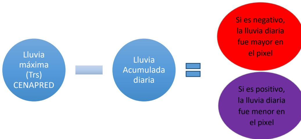
Imagen 25 Esquema de operación de las mallas de lluvia
