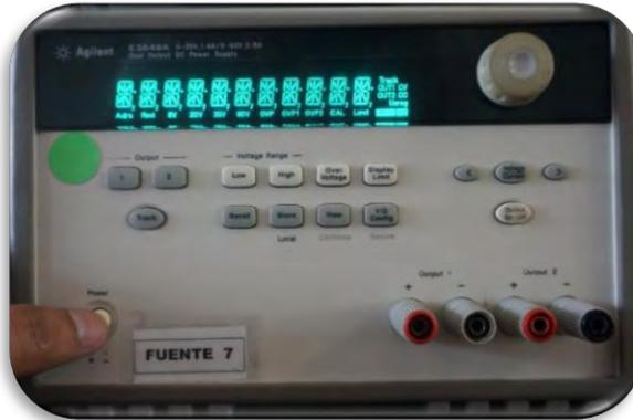
Figura B.3. Encendido de la Fuente de Alimentación.
