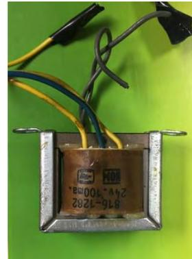
1 Transformador de 127  $V_{\text{RMS}}$  de entrada y 12  $V_{\text{RMS}}$  (si tiene tap central puede ser de 24 V). Con cable y clavija conectados a la entrada.
