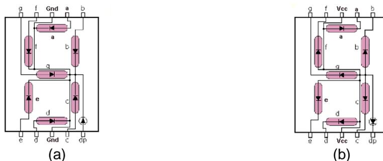
Figura 8.13. Tipos de Display. (a) Cátodo común. (b) Ánodo común.
