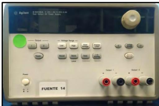
Figura 1.10. Fuente de Alimentación Agilent E3649A.
