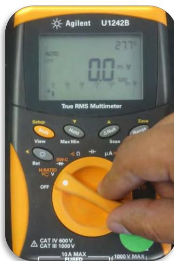
Figura A.2. Perilla colocada en la función de voltaje en directa.
