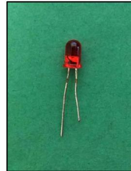
2 Diodos emisores de luz de 5 mm (para este experimento el color no importa)
