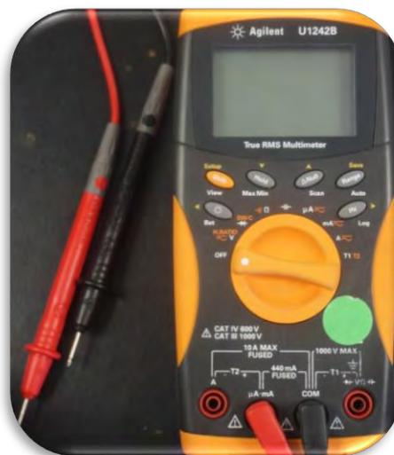
Figura A.4. Conexión de los bananas para medir corriente.
