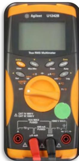
Figura A.10. Colocación de los bananas para medir corriente.
