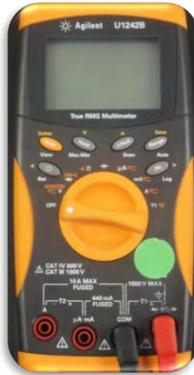
Figura A.7. Colocación de los bananas para medir voltaje.
