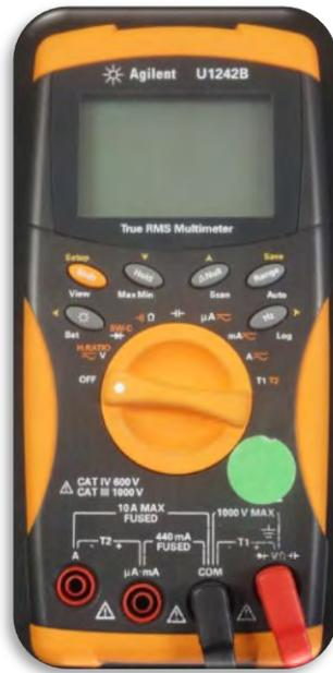
Figura A.13. Colocación de los bananas para medir resistividad.
