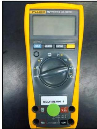
Figura 1.4. Multímetro Fluke 177
