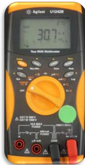
Figura A.8. Perilla colocada en la función de voltaje en alterna.
