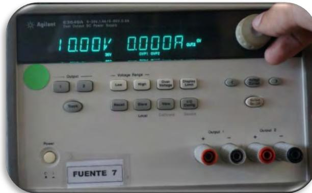
Figura B.10. Configuración de Output 2 a 10 V.
