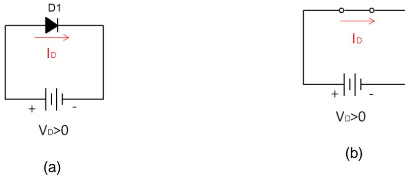
Figura 2.4. Diodo polarizado en directa: (a) Conexión del diodo (b) circuito equivalente
