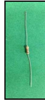
2 Resistores de 3.3 k $\Omega$  a 1/2 Watt.
