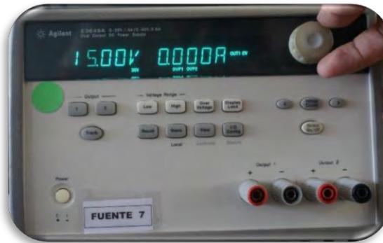
Figura B.7. Configuración de Output 1 a 15 V.
