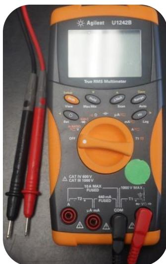
Figura A.1. Conexión de las puntas del multímetro.
