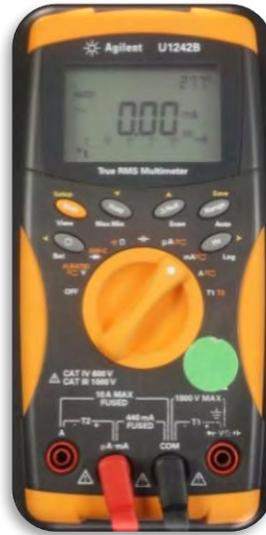
Figura A.11. Colocación de la perilla para medir corriente en alterna.
