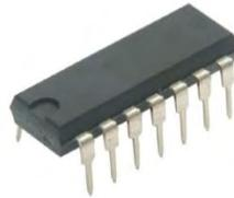
Figura 7.9. Circuito Integrado tipo DIP.
