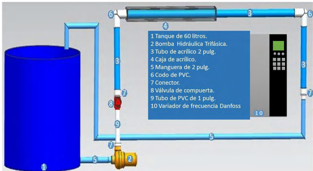
Figura 14 Esquema para realizar las mediciones de los perfiles de velocidad
