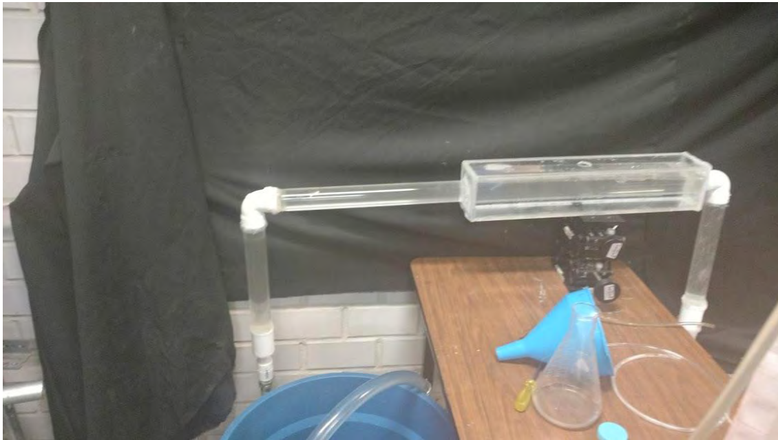
Figura 15 Dispositivo experimental para la obtención de los perfiles de velocidad
