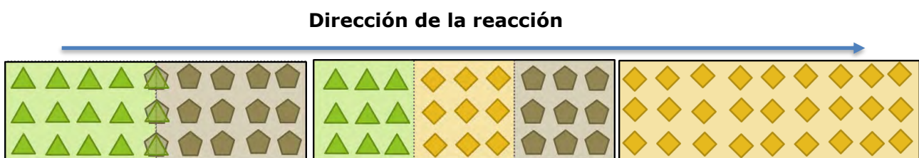
Figura 3.12. Esquema dónde se muestra la evolución de una reacción en estado sólido, la cual está regida por difusión.
