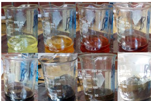
Figura 4.1. Evolución de la síntesis por el método de Pechini
