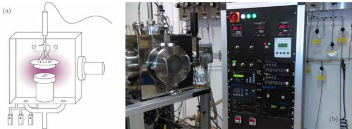
Figura V.1. (a) Representación esquemática del reactor de acoplamiento capacitivo directo utilizado para el depósito por PECVD. (b) Imagen del equipo de depósito de PECVD que se utiliza en este trabajo. Adaptada de 117 .
