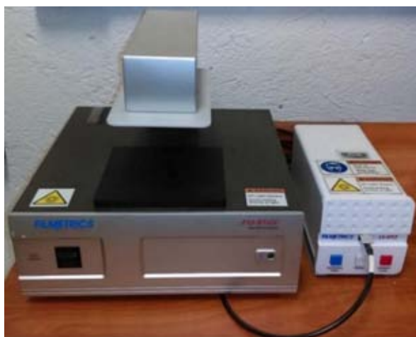
Figura V.9. Imagen del equipo de espectroscopía de transmisión y reflexión óptica que se utiliza en este trabajo.
