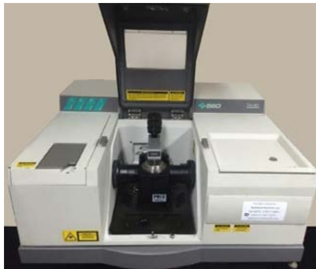
Figura V.2. Imagen del equipo que se utiliza en nuestro laboratorio para las mediciones de FTIR de las películas que se obtienen en este trabajo.
