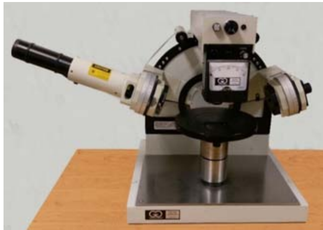
Figura V.8. Imagen del equipo de elipsometría de nulidad que se emplea en este trabajo para la medición del índice de refracción y el espesor de las películas que se obtienen.
