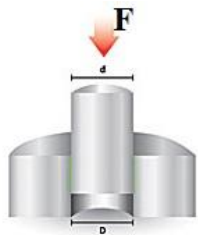
Figura 2.2 Ensamble por interferencia, d > D [25]
