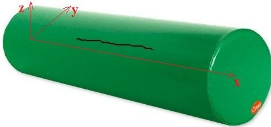
Figura 3.20 Fractura provocada por \sigma_1
