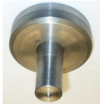
Figura 5.12 Perno embutidor. a) Dibujo b) Perno final
