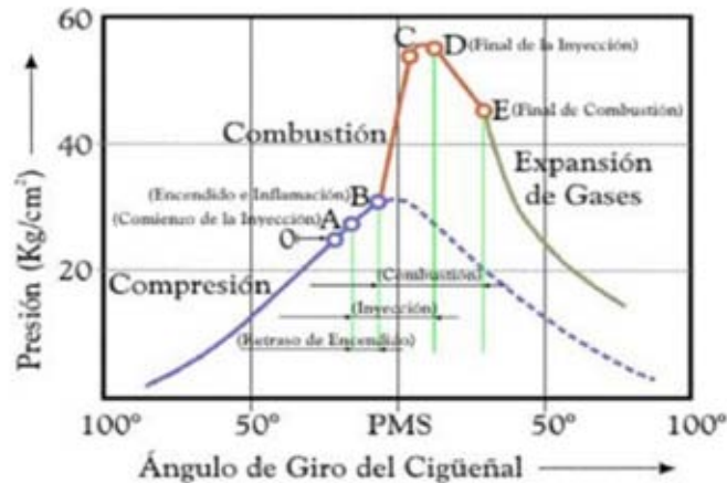
Fig. 1.7 Diagrama ciclo de un motor diesel 9
