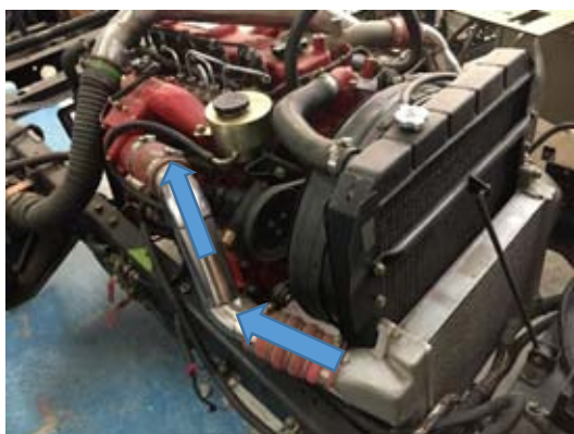
Fig. 5.5 Salida del flujo de aire del Intercooler
