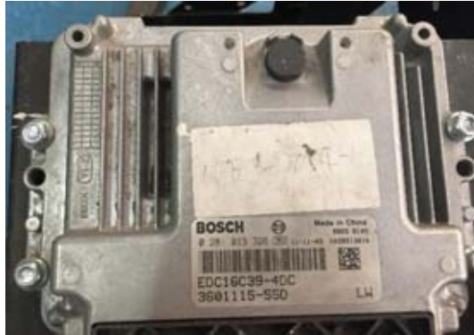
Fig. 5.11 ECU del motor diesel
