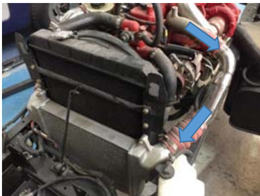
Fig. 5.4 Llegada del flujo de aire al Intercooler
