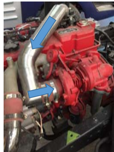
Fig. 5.3 Llegada del aire al turbocargador
