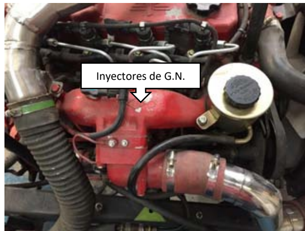
Fig. 5.10 Ubicación de los inyectores de gas natural
