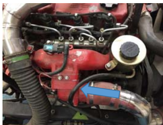
Fig. 5.6 Llegada del flujo de aire al Plenum
