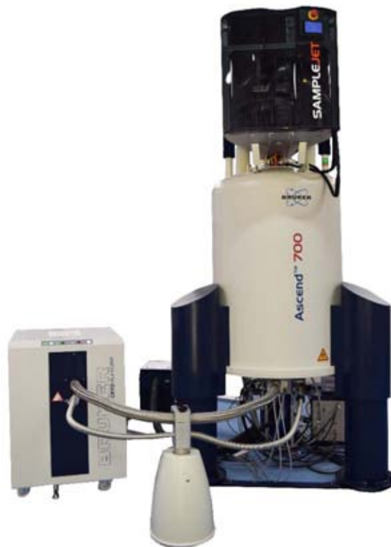
Figura 2. Espectrometro Bruker Avance III de 700 MHz con sistema Sample Jet integrado.
