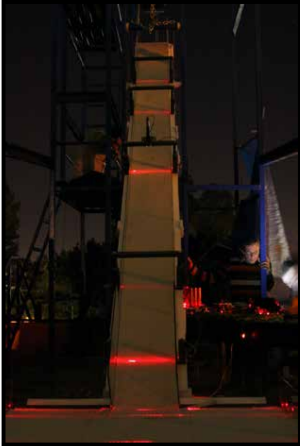
Figura III.6. Fotografía que muestra las barreras láser activadas y en funcionamiento.
