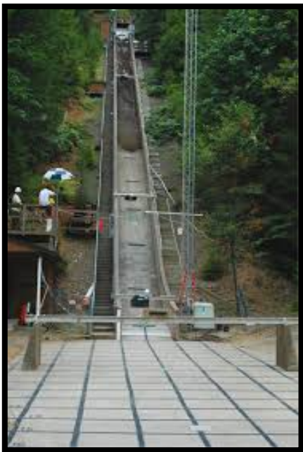
Figura II.7. Canaleta experimental de Richard Iverson (USGS).
