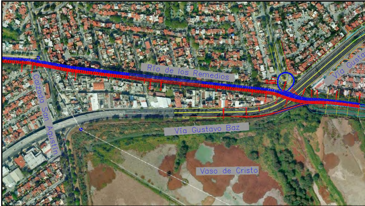
Figura 18. En la siguiente imagen se observa el desarrollo de la alternativa 1 para la etapa dos donde se pretende aprovechar el recorrido del cauce del río de los Remedios, esto para no invadir o afectar a los predios aledaños. Este trazo es la continuación de la alternativa de la etapa 1, que es la alternativa que mejor se ajusta a las necesidades y a la orografía de la zona.
