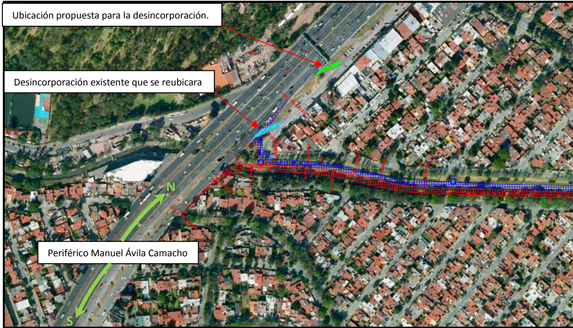
Figura 19. En esta imagen se observa la zona final del trazo donde se pretende realizar la conexión de la autopista Naucalpan – Ecatepec con el periférico, esta conexión se realizara a nivel, pero como se observa actualmente existe una desincorporación de los carriles centrales hacia los carriles laterales y con la propuesta de salida de la Autopista estaría afectando esta salida, por lo cual es necesario desplazarla aproximadamente 140m hacia el norte.
