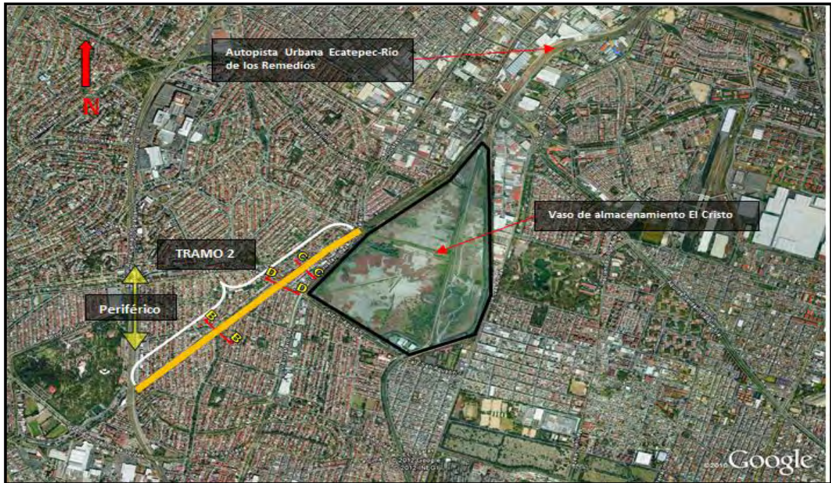
Figura 21 En la imagen se observa la zona de propuesta de ampliación para la segunda etapa del viaducto de conexión así mismo el Vaso de almacenamiento “El Cristo” sobre el cual una parte de esta ampliación tendrá una invasión.
