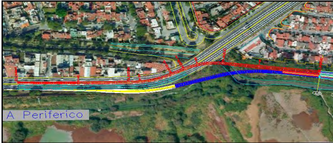
Figura 2. Conexión de la Autopista Naucalpan – Ecatepec con la vía Dr. Gustavo Baz. Es esta imagen se puede observar la conexión de las autopistas mediante gazas de cambio de nivel, esto con el fin de que la afectación de la vía Gustavo Baz sea la menor posible, para que el ajuste geométrico sea solo en el tercer carril.
