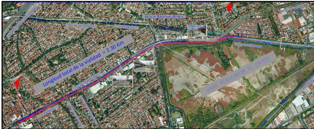
Figura 20 En esta imagen se aprecia la geometría de la alternativa 2, para la segunda etapa de prolongación de la autopista Naucalpan – Ecatepec, hasta el Boulevard Manuel Ávila Camacho (Periférico) por la Vía Dr. Gustavo Baz Prada. Con la que se permite el flujo de los vehículos sin complicaciones pues los radios de giro están diseñados para que el conductor tenga la confianza de circular por estas vías.
