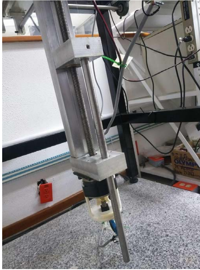
Figura III. Barra terminal final del posicionador.
