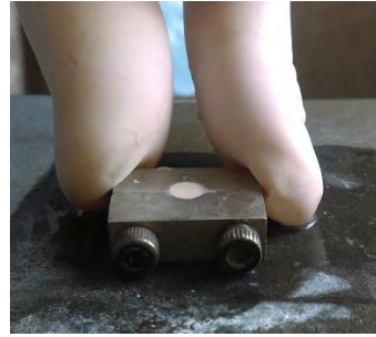
Foto 29. Se pule la muestra por ambos lados.
