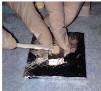
Foto 10. Se coloca el material en el molde.
