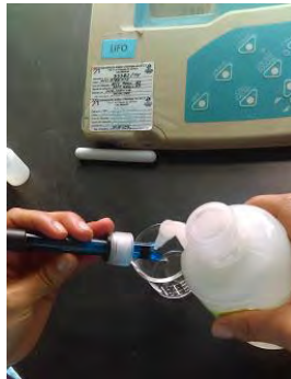
Foto 27. Se enjuaga el electrodo con agua desionizada.
