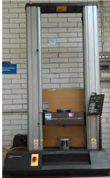
Foto 17. Máquina Instron para la prueba de resistencia a la compresión.
