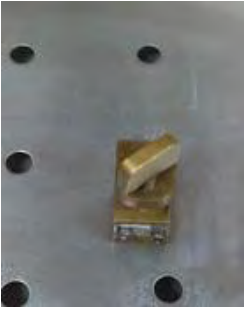
Foto 28. Muestra en la prensa con tornillo en la estufa de control de temperatura.
