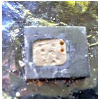
Foto 14. El molde del cemento con las indentaciones.
