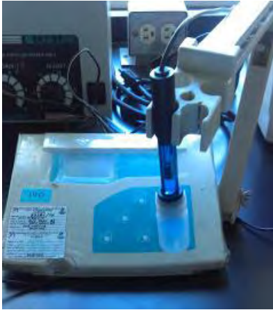
Foto 24. Potenciómetro aparato para medir pH.
