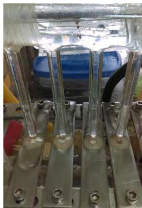
Foto 31. Se colocan las muestras en el aparato bajo del chorro.
