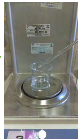
Foto 23. Se pesa el ácido en la balanza.
