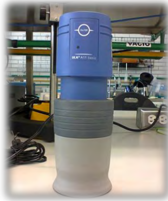
Figura 7. Molino criogénico utilizado en la experimentación (IKA A11 Basic)
