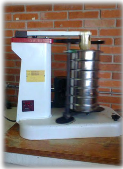
Figura 9. Instrumento Ro-Tap utilizado en el análisis granulométrico
