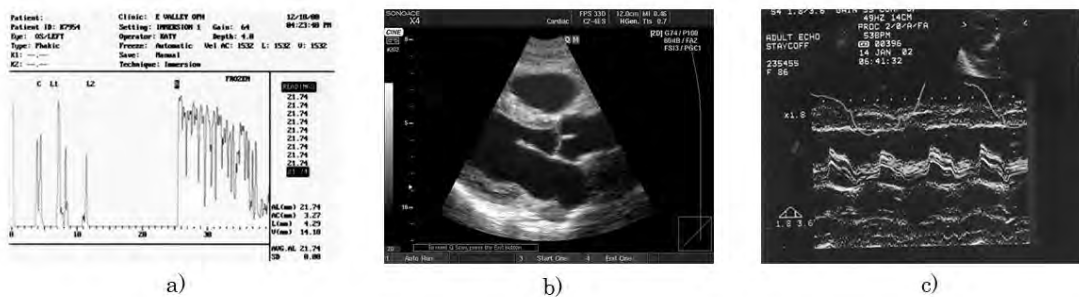
Figura 1.1. Diferentes modos de visualización de datos de ultrasonido: a) A-scan; b) B-scan y c) M-mode [6].
