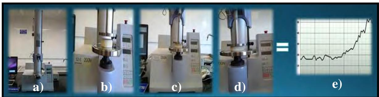
**Fig. 2.11** Determinación de compresión uniaxial. Texturómetro SHIMADZU EZ-S.
