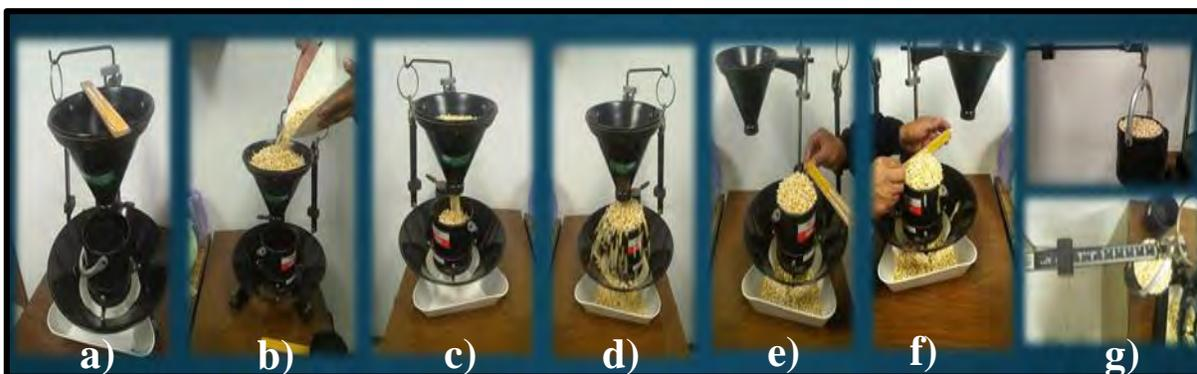
Fig. 2.3 Determinación de peso hectolítrico del grano de maíz.
