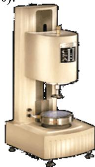
Fig. 1.4 Reómetro.
