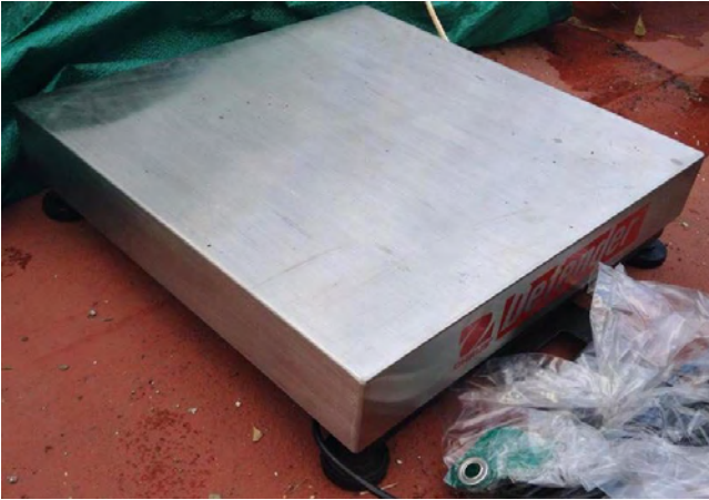
Figura 16. Báscula Ohaus Defender (Defender 3000) empleada para pesar las macetas. Plataforma (izquierda), indicador de peso (derecha).
