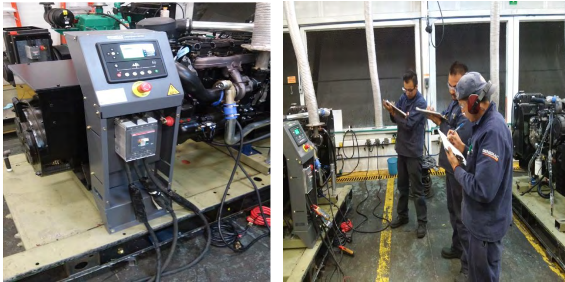
Imagen 3.11 Fase de toma de mediciones; en la imagen izquierda se muestra el equipo preparado para el arranque inicial de acuerdo al procedimiento de la compañía y en la imagen derecha se visualizan a los técnicos tomando las mediciones.
