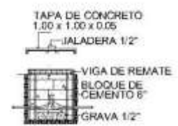
REGISTRO ELECTRICO CORTE A-A
