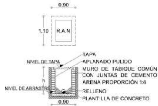
CREGISTRO DE AGUAS NEGRAS
