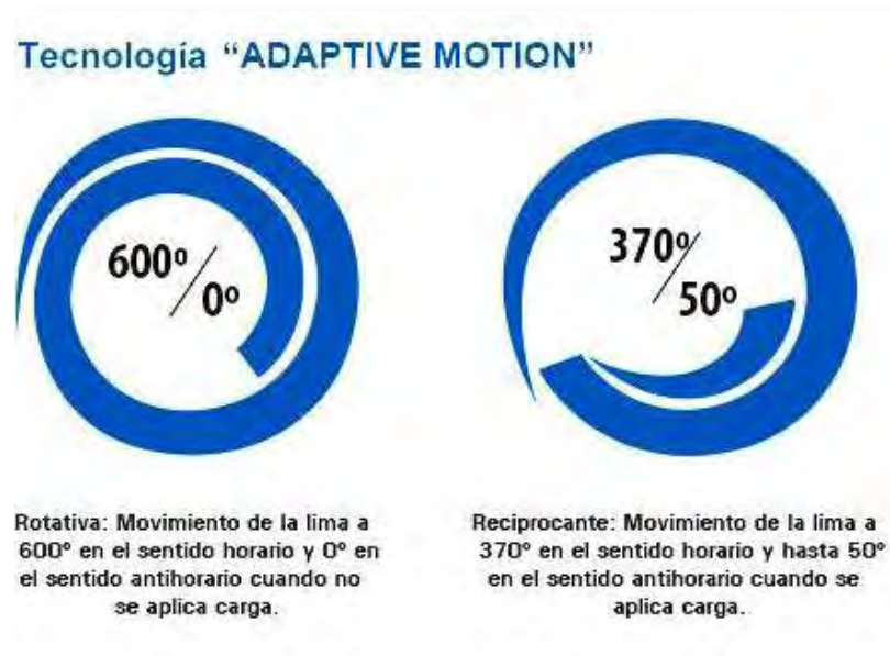
Fig. 17 Figura de los movimientos de tecnología Adaptive Motion: rotación de 600° en sentido horario y de 0° en sentido anti-horario cuando no es aplicada carga (a); movimiento recíprocante de 370° en sentido horario y hasta 50° en sentido anti-horario cuando el instrumento recibe carga durante su empleo (b). (fuente: Lima M.) (10)
