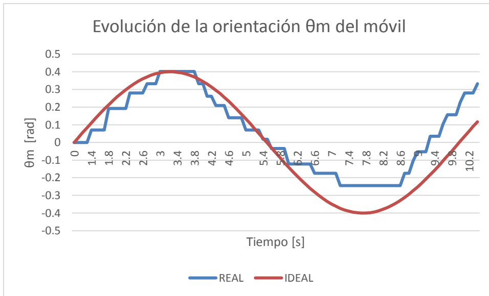
Gráfica 6. 6 Caso de estudio B. Evolución en la orientación \vartheta_m del móvil
